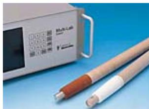
Figura 4.10 - Medidores de oxigênio ativo utilizados.
