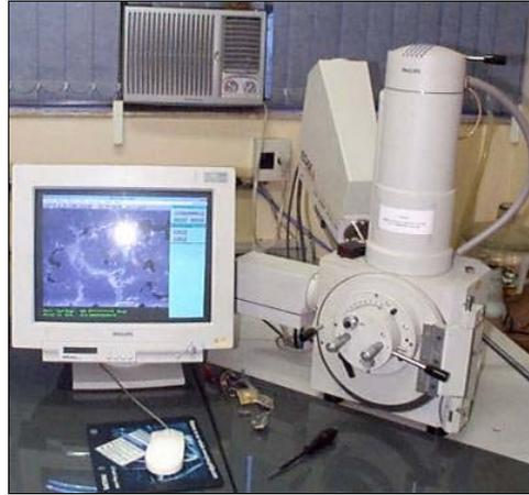
Figura 4.15 - Microscópio Eletrônico de Varredura com Microsonda EDS acoplada.
