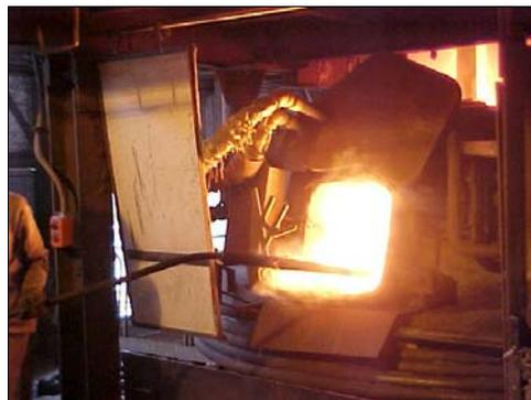
Figura 4.12 - Amostragem no forno-panela.
