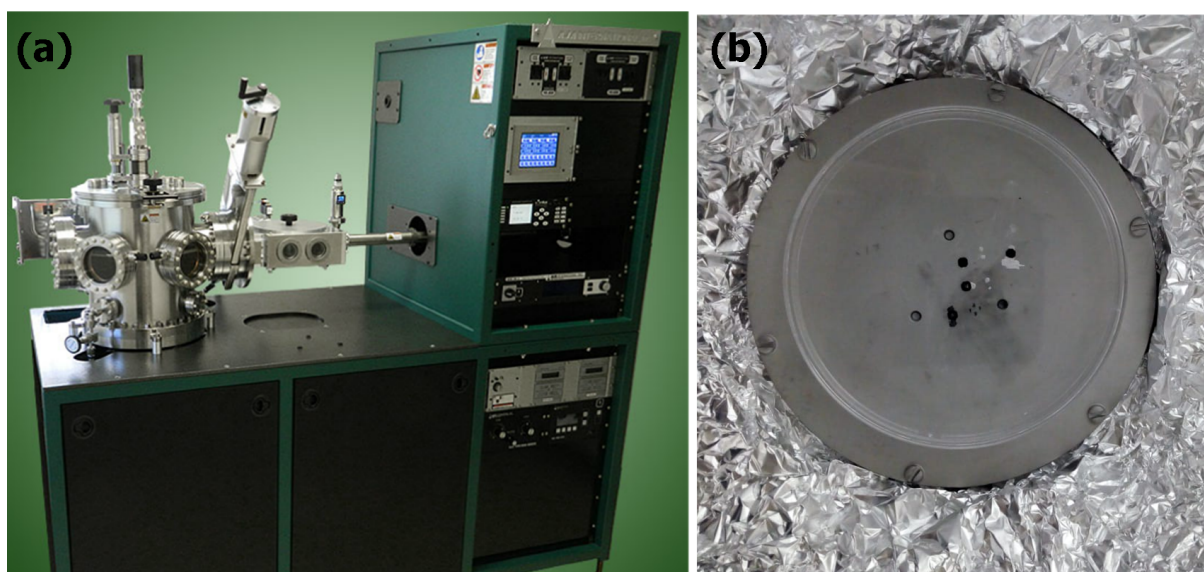
Figura 16 – (a) Sistema de deposição AJA Orion UHV-8; (b) Porta-amostras utilizado mostrando as amostras coladas com cola prata e cola carbono.
