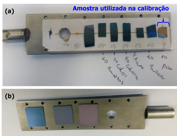
Figura 18 – Porta-amostras utilizado na linha de RBS do Laboratório de Implantação Iônica. Em (a) é mostrado o porta-amostras com a amostra de Au utilizada para calibração dos detectores (destacada em azul); em (b) é mostrado um conjunto de amostras analisadas via RBS, as cores diferentes indicam diferentes espessuras de filme.
