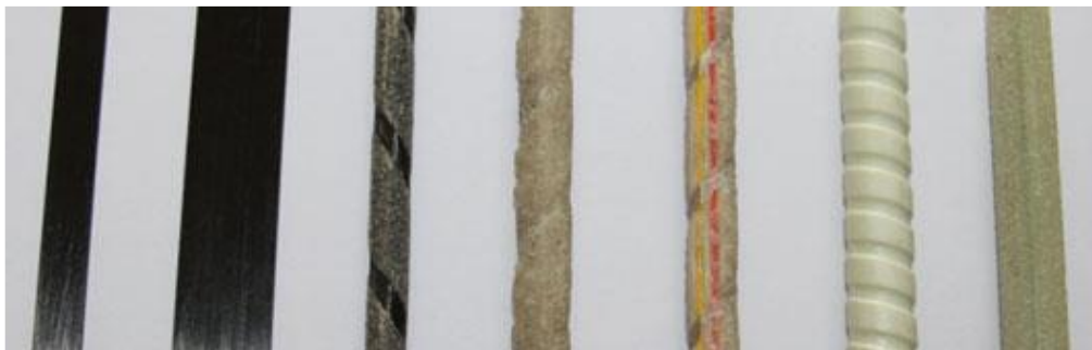
Figura 2.8 - Geometria de barras e laminados NSM.
