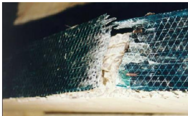
Figura 5.10 - Ruptura da lâmina de reforço da viga com única camada de reforço.
