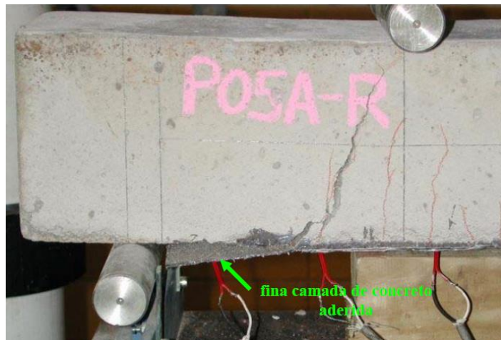
Figura 1.3 - Peeling off na zona de ancoragem.
