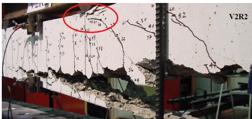
Figura 5.36 - Esmagamento localizado da viga V2R2 de Fortes (2004).
