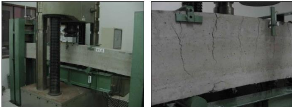
Figura 1.4 - Ensaio à flexão de viga reforçada com PRFC.
