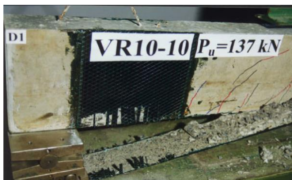
Figura 5.11 - Reforço lateral realizado nas vigas com sete e dez camadas, envolvendo, inclusive, o reforço longitudinal.
