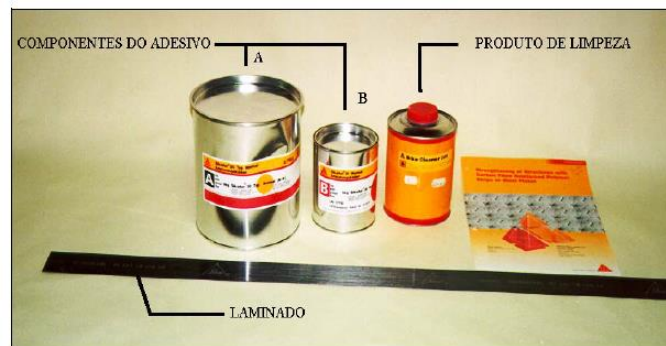
Figura 2.1 - Componentes de um sistema pré-fabricado com laminados de PRFC.
