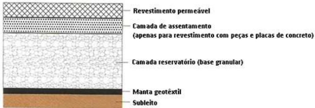
Figura 3.10 – Seção típica de um pavimento permeável (fonte: adaptado de CANHOLI, 2005)
