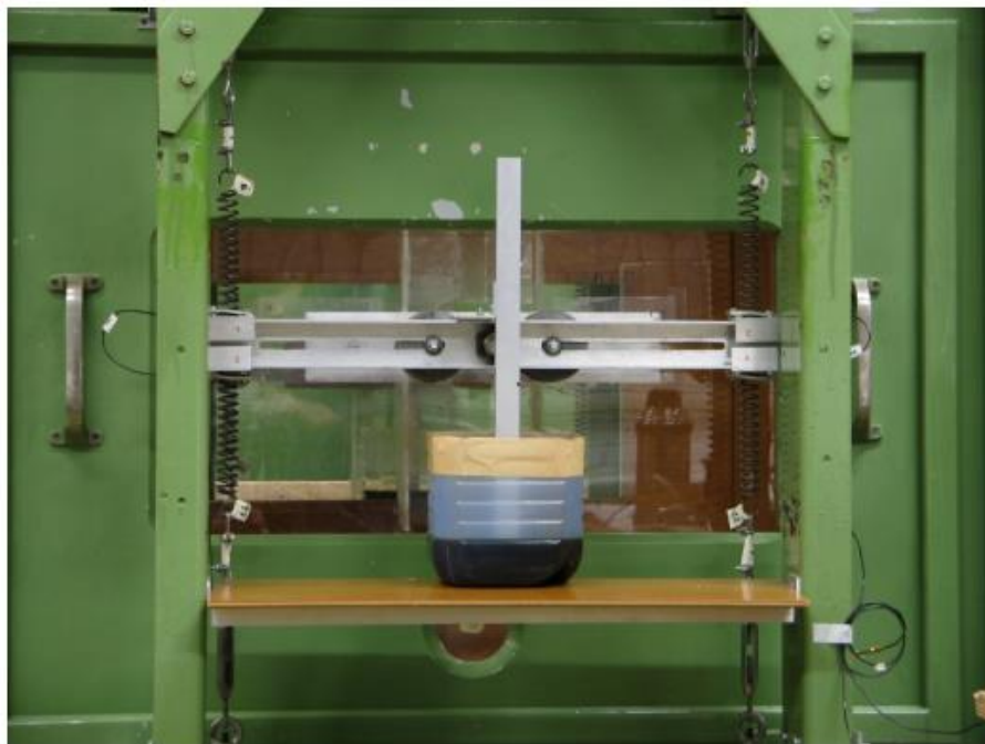
Figura 1.3 – Sistema de apoio elástico do modelo dinâmico com dispositivo para incremento de amortecimento do sistema. (NÚÑEZ, 2008).
