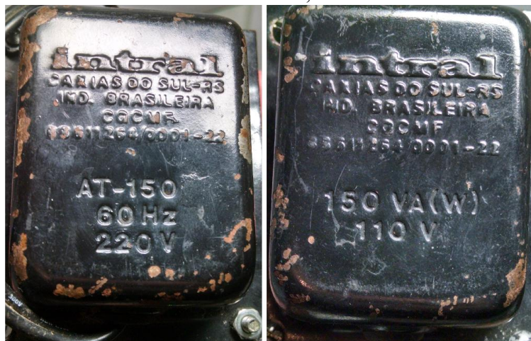
Figura 21: Placa de identificação do transformador utilizado nos ensaios do projeto. Transformador 127/220 V, 150 VA e 60 Hz.
