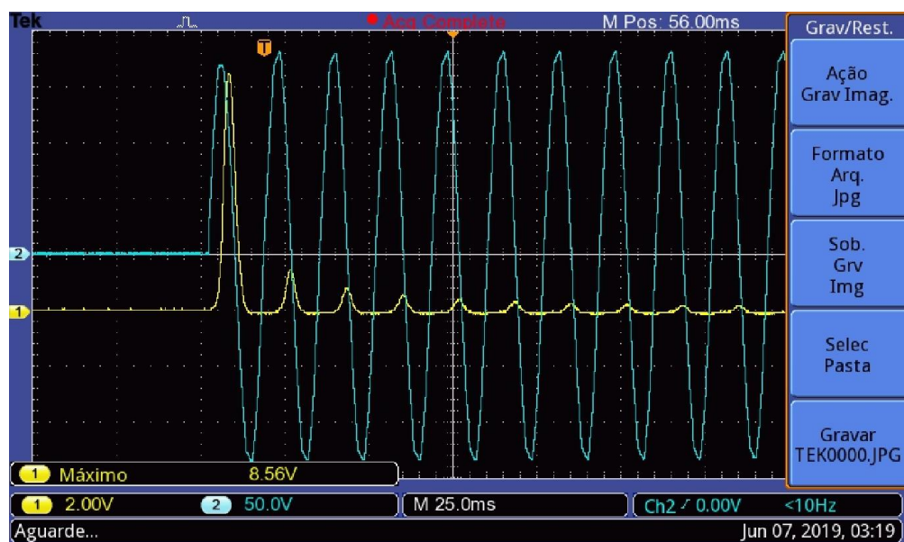
Figura 36: Energização em ângulo 0^\circ . Observa-se a tensão de pico de 8,56 V, o que corresponde a uma corrente de pico de 8,1 A.
