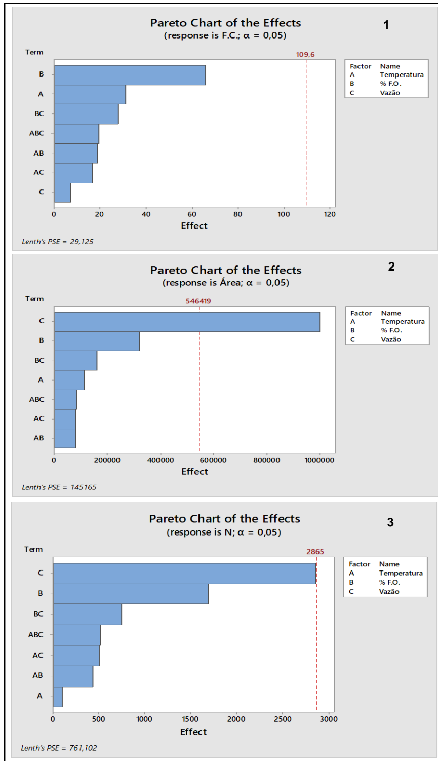
Figura III - 6 Gráfico de Pareto representando os efeitos dos fatores e da interação entre os fatores para as respostas (1) Fator Cauda (F.C.), (2) Área do pico cromatográfico e (3) Número de pratos teóricos (N).
