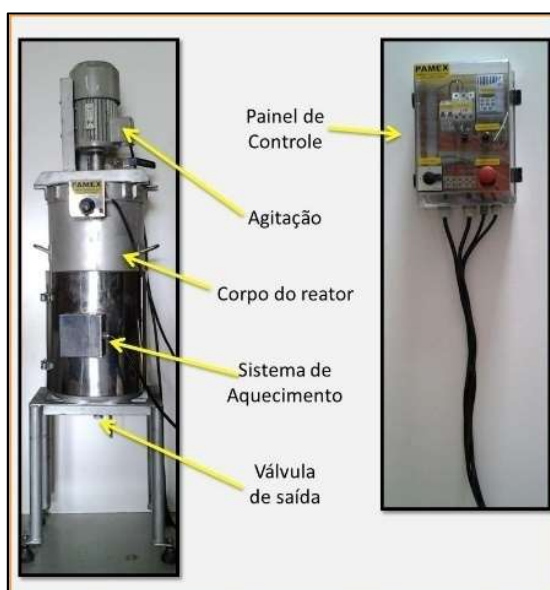
Figura 18: Fotografia do reator equipado com sistema de agitação, aquecimento e painel de controle (volume do reator é de 60 L)
