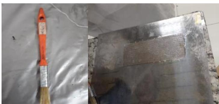
*Figura 19 - Pincel utilizado para a impregnação do tecido com resina sobre uma chapa de metal. Fonte: Autor*
