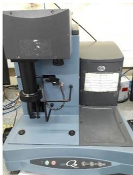
*Figura 20 - Equipamento utilizado na análise de TG - TGA Q50 TA Instruments. Fonte: Autor*
