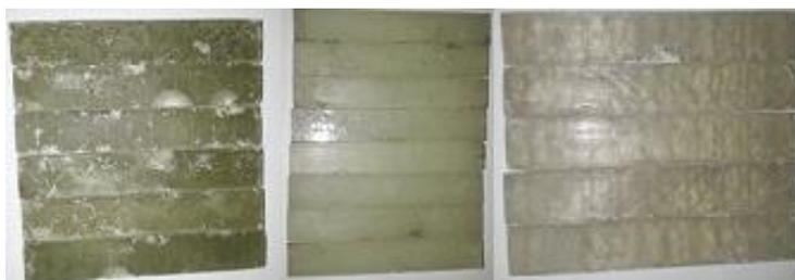
*Figura 12 - Corpos de provas produzidos com MMA, resina epóxi e com estireno da esquerda para direita.*
