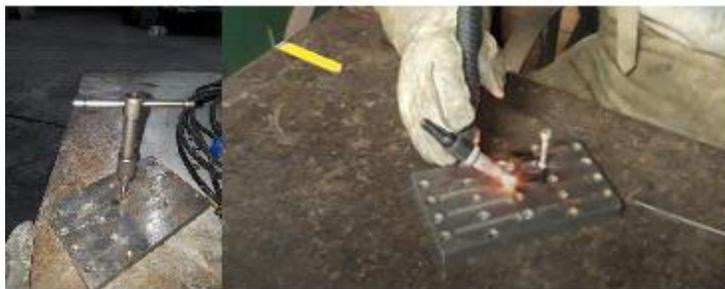
*Figura 16 - Molde metálico passando por um pré-tratamento antes de receber os corpos de prova. Fonte: Autor*
