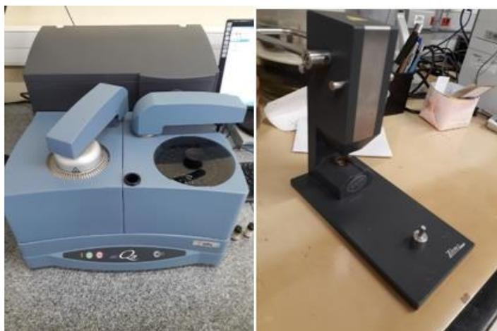
Figura 21 - Equipamento utilizado na análise de DSC - Q20 – TA Instruments. Fonte: Autor
