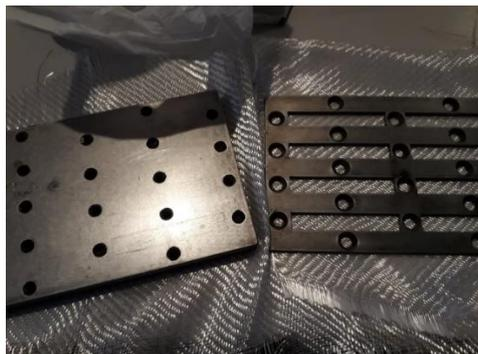
Figura 17 - Molde metálico pronto para a laminação. Fonte: Autor
