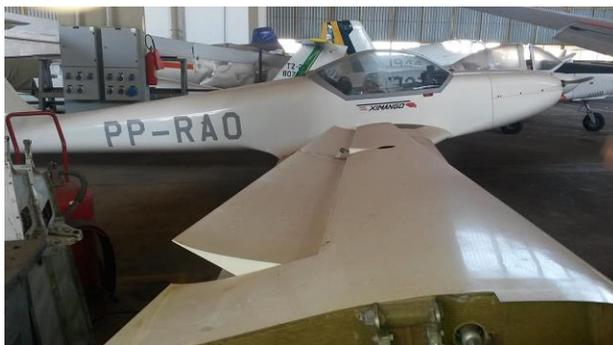
Figura 1 – Planador feito com material compósito de fibra de vidro e resina epóxi. Fonte: Autor
