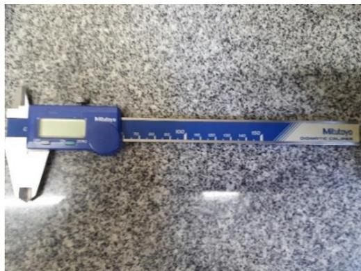
*Figura 24 - Paquímetro digital utilizado para medir as dimensões dos corpos de prova. Fonte: Autor*
