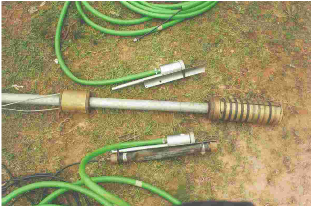
FIGURA 6. 19 Sistema de geração de ondas S desenvolvido e cápsulas com acelerômetros.
