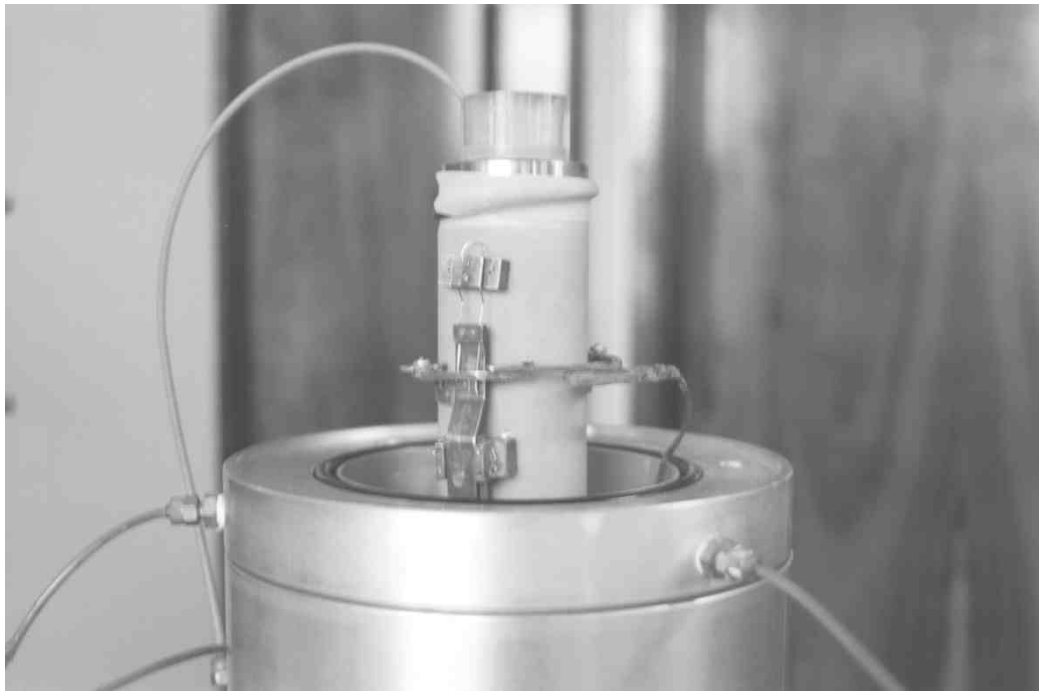
FIGURA A. 12 Detalhe da instrumentação local de deformações radial e axial utilizada, a base de sensores de efeito Hall (Soares, 1992).
