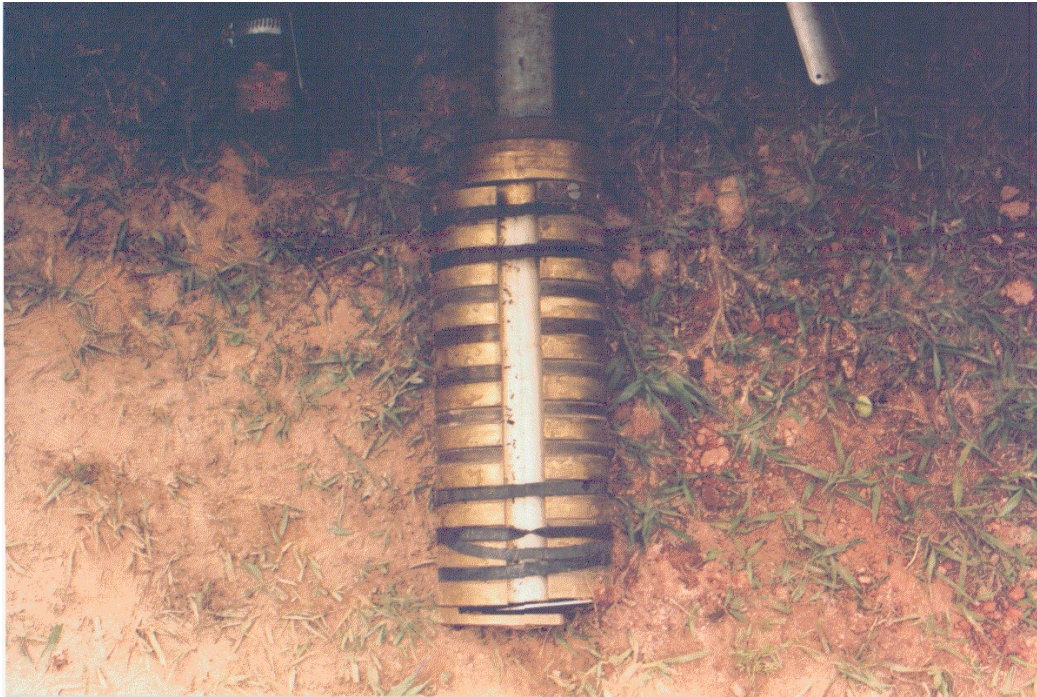
FIGURA 6. 20 Detalhe do martelo expandido.
