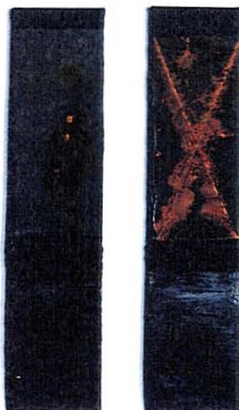
Fotografia 3.2 – Névoa salina de filmes de Ppy com TiO 2 após 5 horas de ensaio: amostra da esquerda sem entalhe, amostra da direita com entalhe em X.
