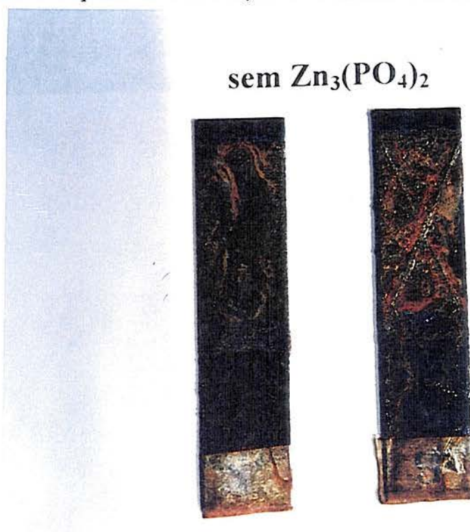
Fotografia 3.7- Névoa salina de filmes de Ppy sem fosfato de zinco ZMP após 24 horas de ensaio: amostra da esquerda sem entalhe, amostra da direita com entalhe em X.
