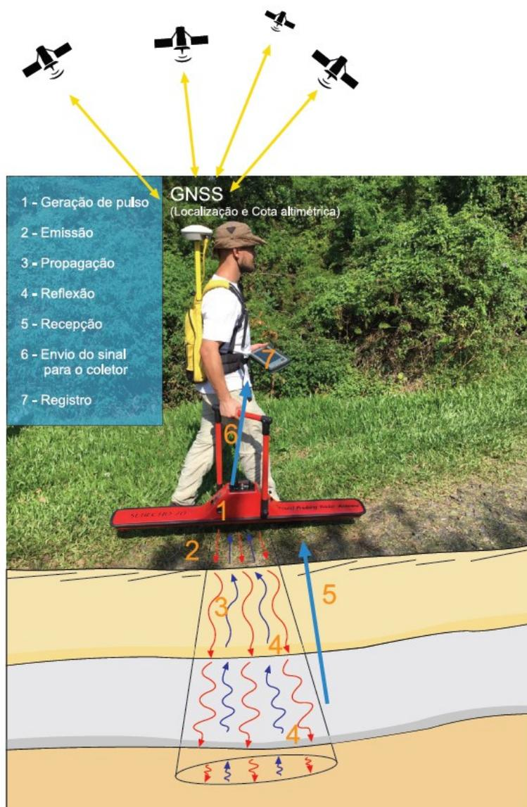
Figura 14: Etapas envolvidas por meio do método do georradar e esquema demonstrativo de obtenção de cota altimétrica pelo sistema GNSS.
