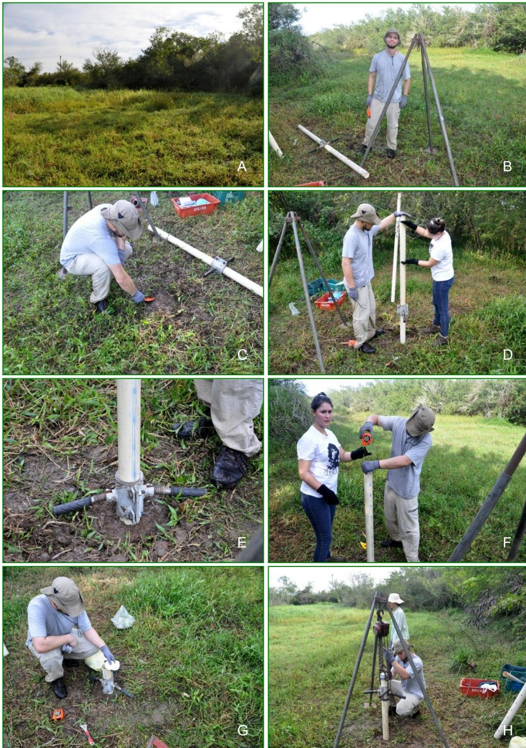
Figura 16: Etapas para testemunho de sondagem durante o período de campo.
