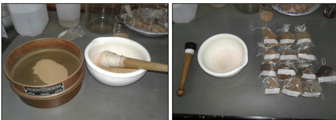
Figura 17: a) Processo de maceramento e peneiramento das amostras; b) Identificação das amostras para posterior análise.
