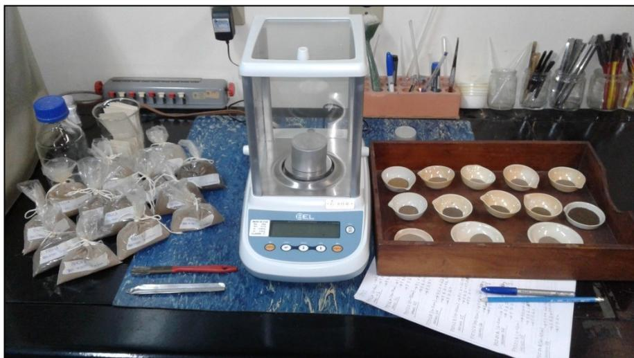
Figura 18: Processo de pesagem das amostras em cadinhos para posterior calcinação.
