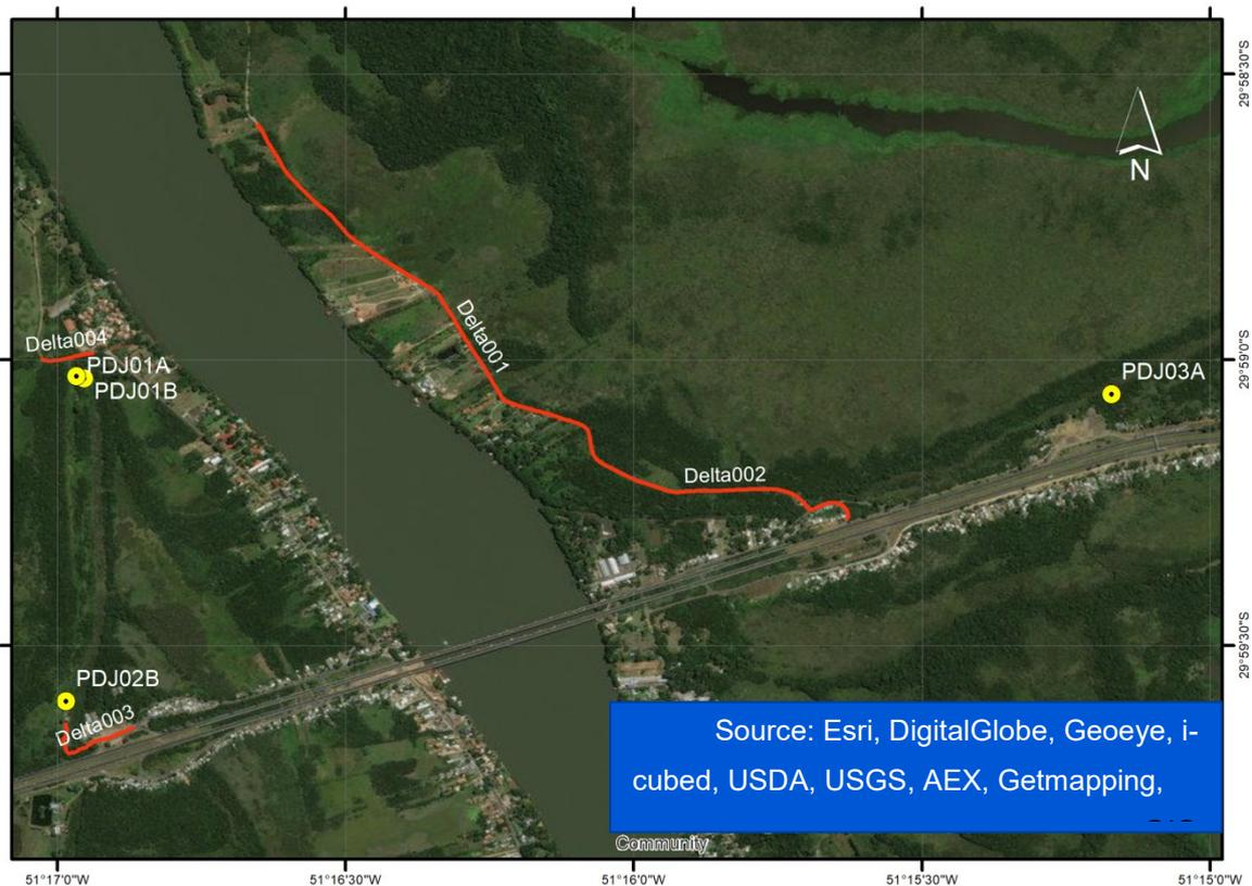
Figura 15: Localização dos furos de sondagem PDJ01A, PDJ01B, PDJ02A, PDJ02B e seções geofísicas Delta001, Delta002, Delta003 e Delta004, levantadas com equipamento de GPR.
