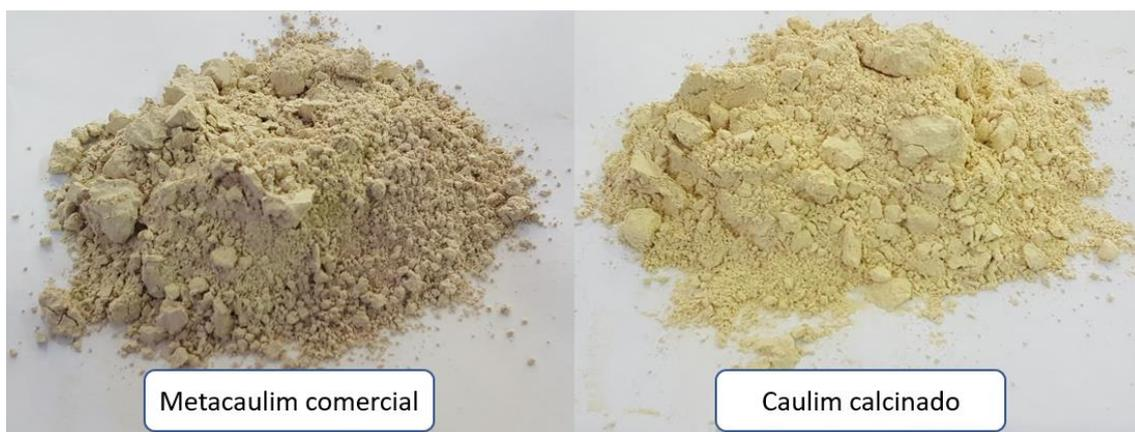
Figura 11: Fotos do metacaulim comercial e calcinado em laboratório
