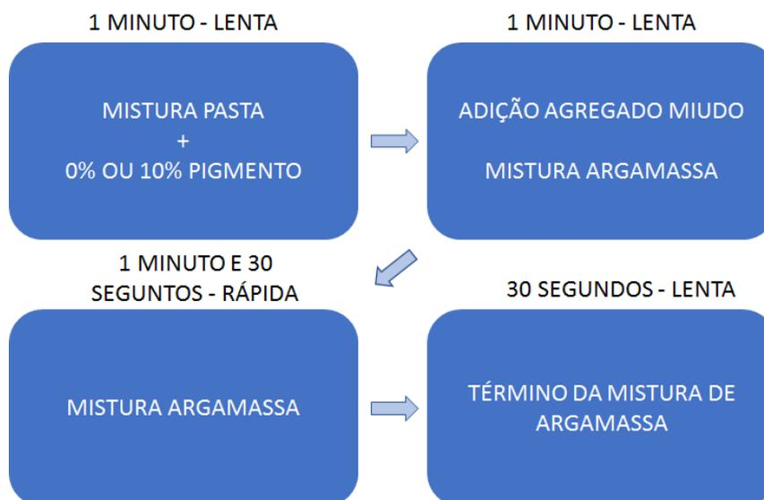
Figura 12: Método de mistura das amostras
