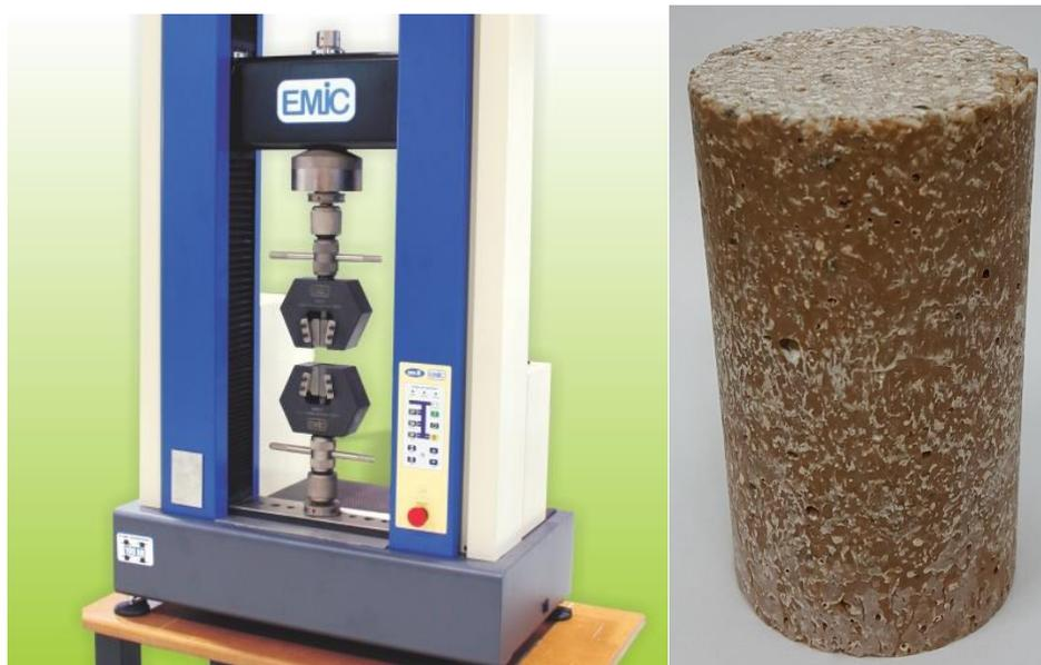
Figura 13: Modelo da prensa utilizada nos ensaios de resistência mecânica à esquerda, corpo de prova retificado à direita
