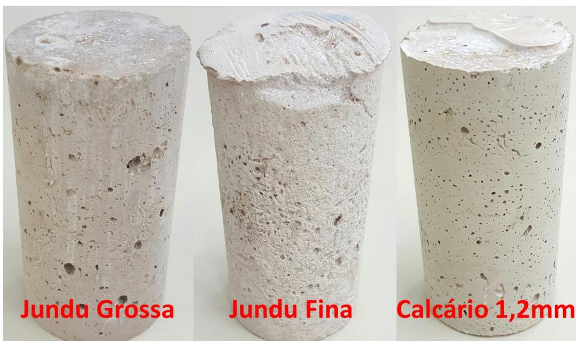
Figura 17: Corpos de prova cilíndricos com os três tipos de areia.
