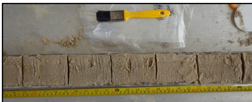
Figura 13: Imagem da separação das alíquotas de 10 cm do testemunho
