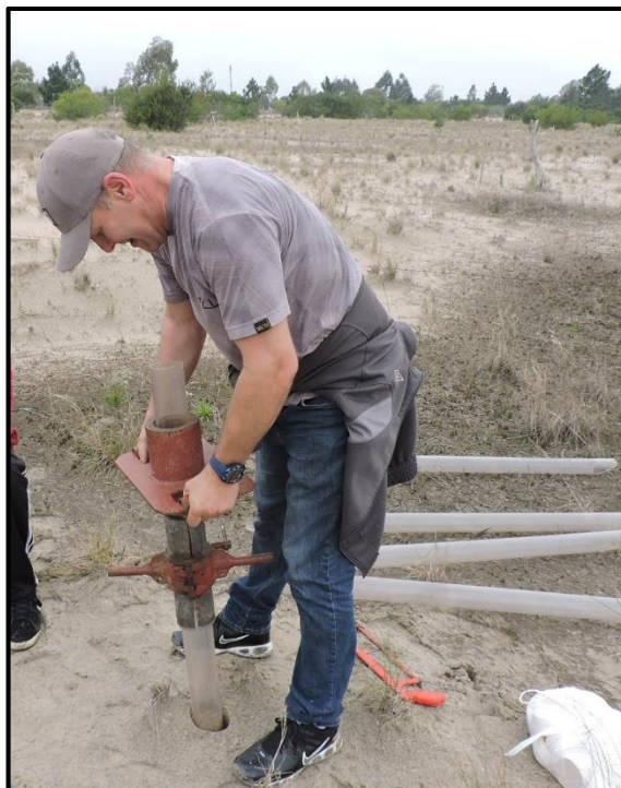
Figura 9: Perfuração dos testemunhos com o auxílio do percursor
