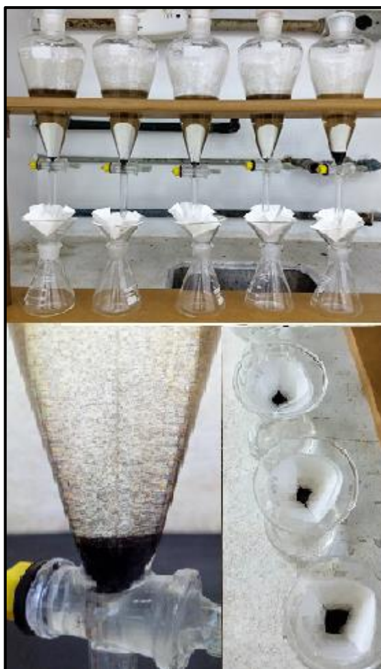
Figura 15: Análise de decantação de minerais pesados por bromofórmio.
