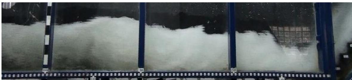
**Figura 9.** – Ressalto hidráulico a jusante de vertedouro em degraus com aeração natural.
