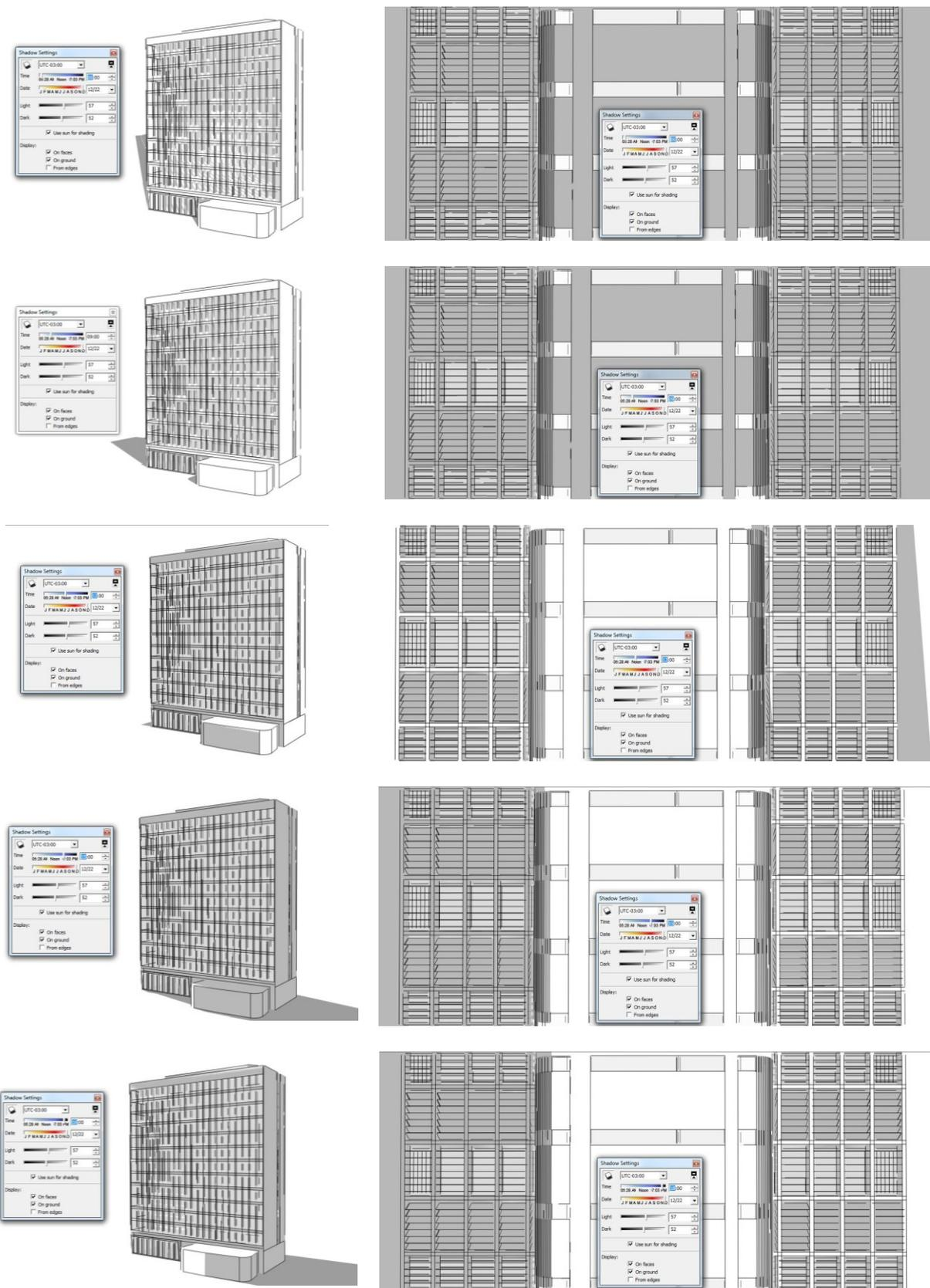
Fig. 3.54: Edifício Souza Naves / INSS, perspectivas externas elevação frontal Sul Sudeste e detalhe do controle adotado na elevação posterior Nor Noroeste, expondo o controle ambiental no Verão, dia 22 de Dezembro às 06h00, 09h00, 12h00, 15h00 e 18h00 respectivamente linha a linha.
