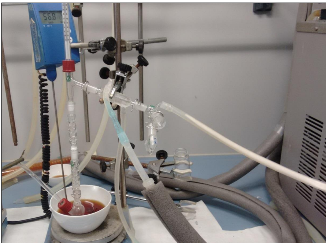
Figura 15. Tentativa de fracionamento do óleo essencial de Eucalyptus saligna por microdestilação.
