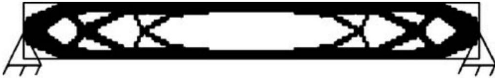
Figura 5.2 Viga biapoiada otimizada por Du e Olhoff, 2007.
