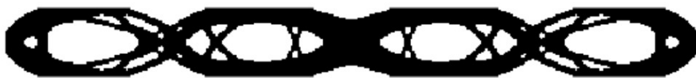
Figura 7.11 Topologia para separação das frequências naturais no entorno da frequência de 120Hz, neste trabalho.
