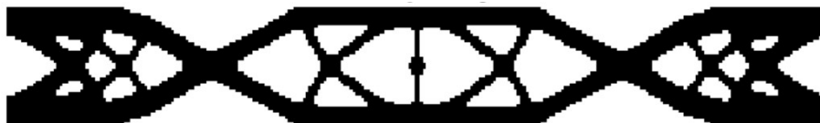
Figura 5.10 Viga biengastada, topologia ótima obtida neste trabalho.
