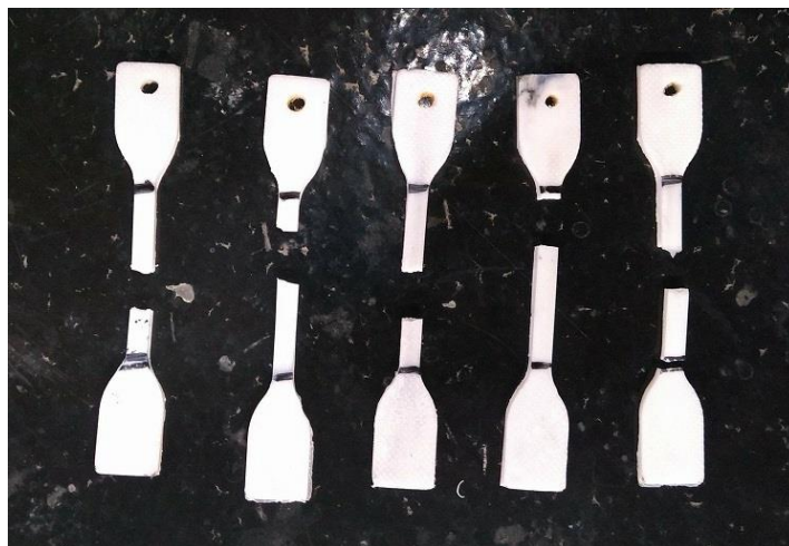
Figura 21: Amostras de BLENDA INJ 40 após ensaio de tração.
