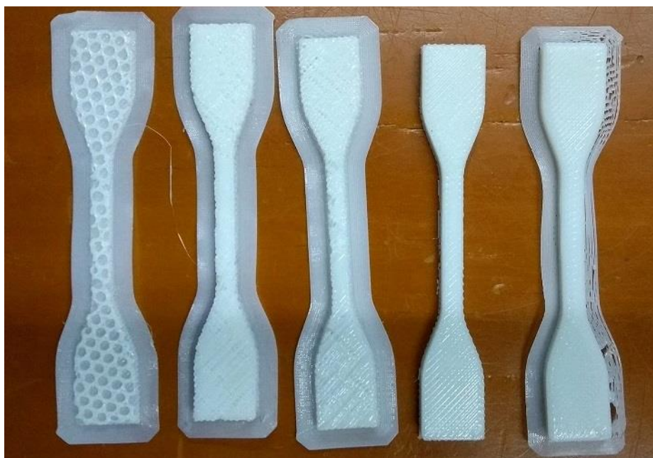
Figura 13: Peças produzidas nos testes para definição dos parâmetros de impressão.
