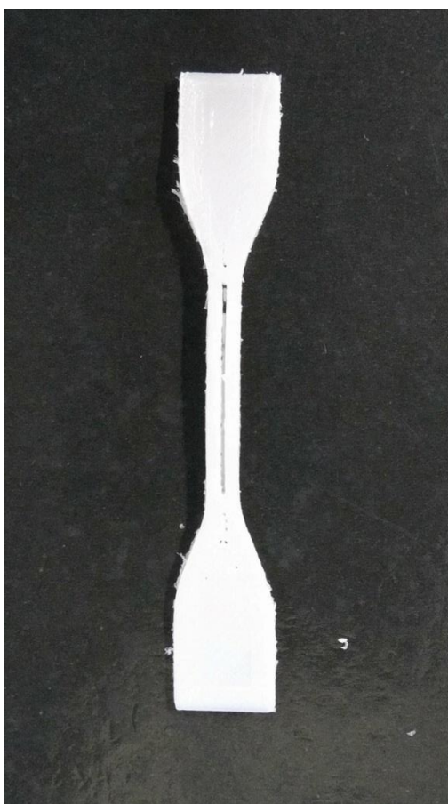
Figura 12: Amostra impressa com o máximo de espessura de borda, base e topo. É possível identificar um vazio no meio da área útil da peça.
