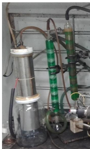
Figura 14: Sistema de condensação contendo dois condensadores e um precipitador eletrostático (à esquerda).
