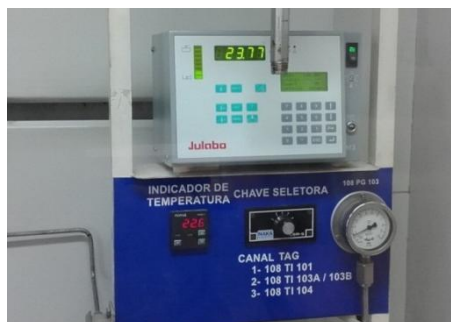
Figura 9: Sistema de controle de temperatura do sistema de torrefação.
