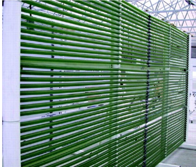
Figura 2.3: Fotobiorreator tubular em operação Fonte: Greenwell et al. (2010).
