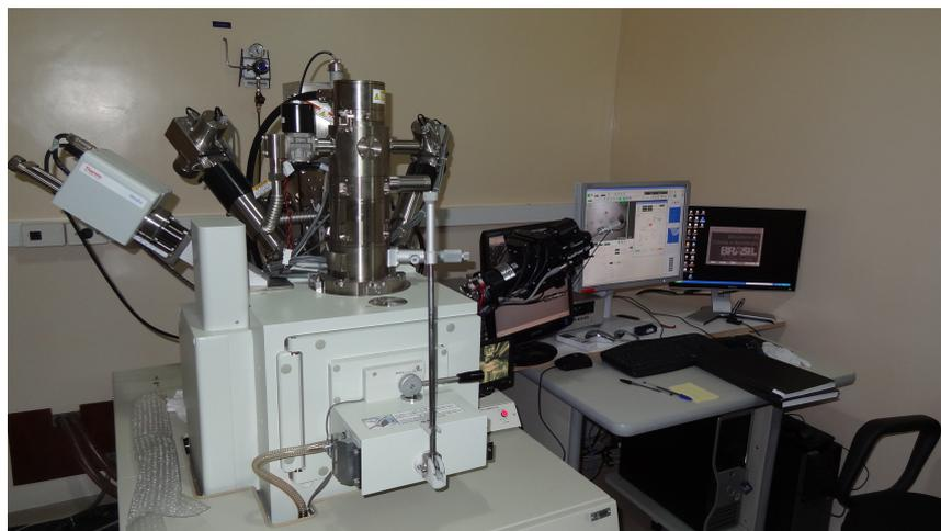
**Fig. 3.4:** Sistema de duplo feixe (marca Jeol modelo JIB 4500) localizado no LCN do IF-UFRGS.
