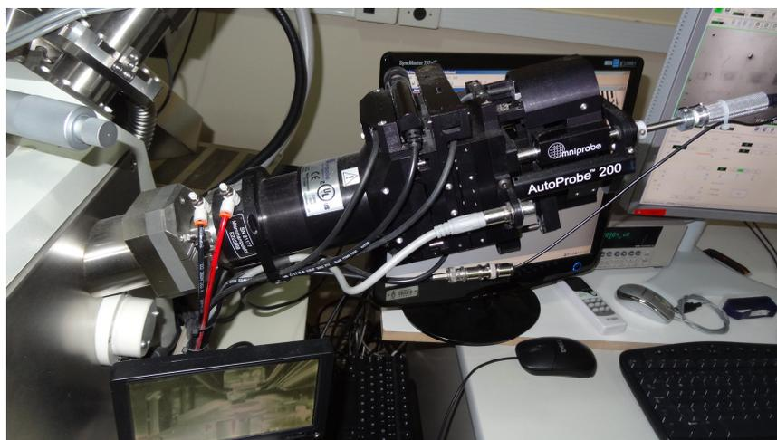
**Fig. 3.8:** *Nanomanipulador Autoprobe200, anexado ao sistema de duplo feixe JEOL JIB4500 do LCN (IF-UFRGS).*
