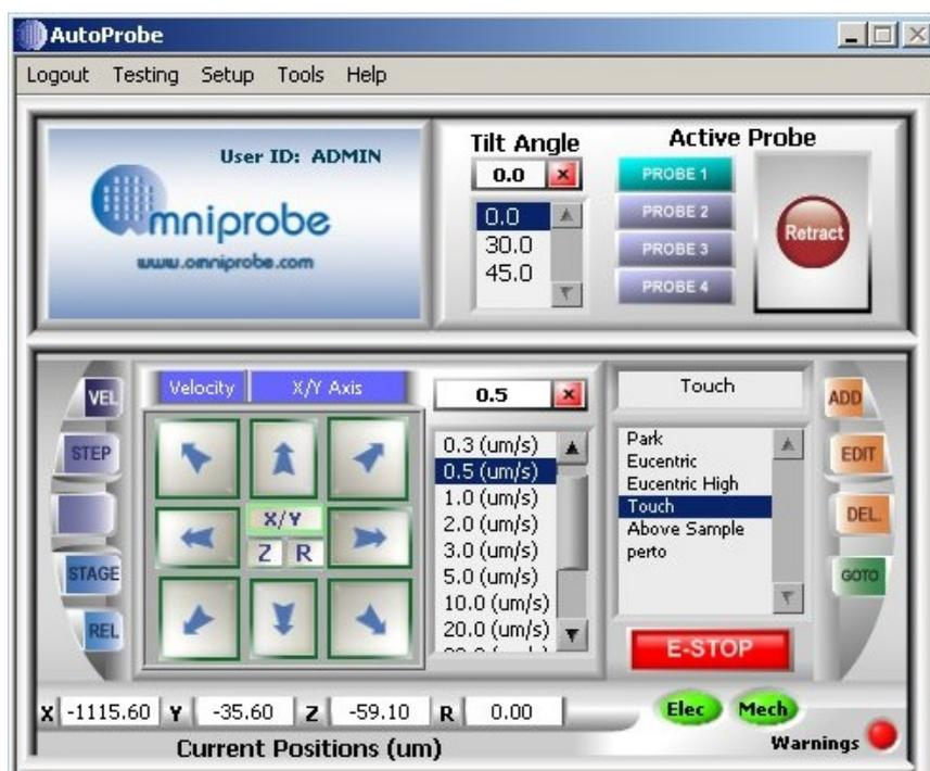
Fig. 3.11: Tela do software de controle do sistema nanomanipulador.
