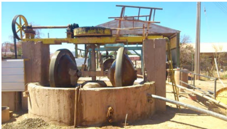
Fotografia 31: Trapiche , Usina de tratamento.
