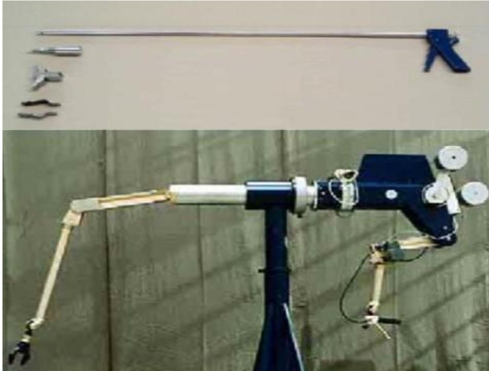
Figura 2: Pinça de manipulação remota (acima) e manipulador mestre-escravo (abaixo) (IAEA, 2004).
