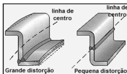
Figura 3.12- Deposição do cordão sobre a linha neutra como método de prevenção à distorção [Adaptado TWI, 1988].
