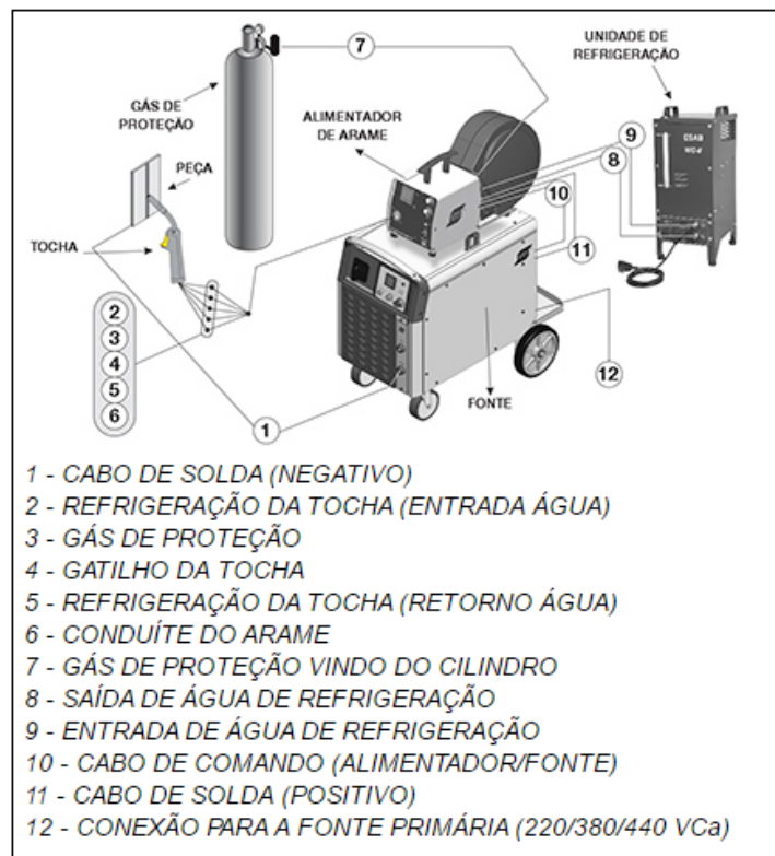
Figura 3.22- Equipamentos básicos do processo de soldagem MIG/MAG [ESAB, 2014].
