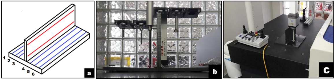
Figura 4.8- (a) Em azul, linhas de mapeamento de coordenadas dos corpos de prova. (b) e (c) Medições sendo realizadas.
