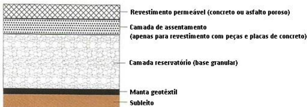
Figura 8 – Seção típica de um pavimento permeável
