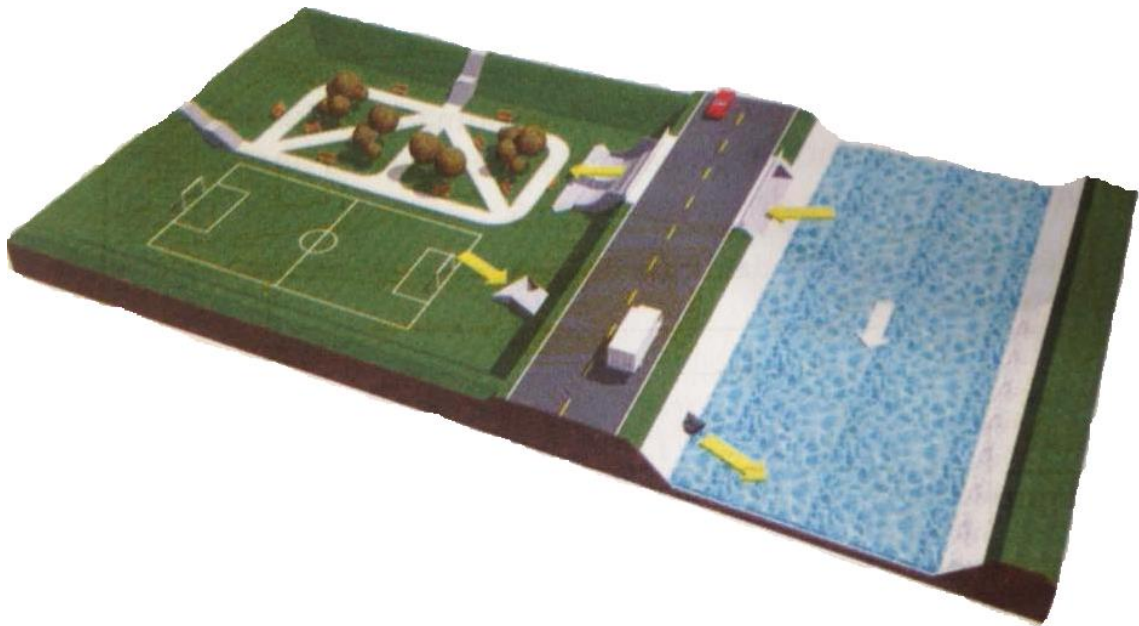
Figura 6 – Detenção off-line integrada à recreação
