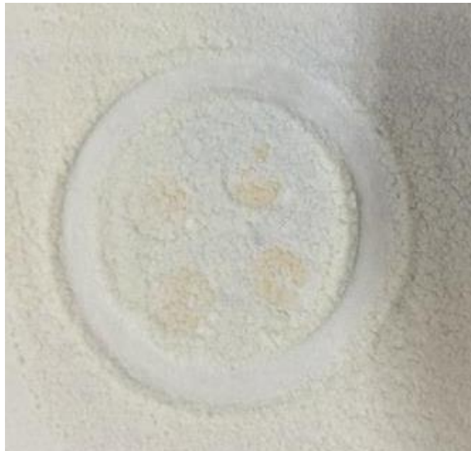
Figura 5-4. Leito de \text{Al}_2\text{O}_3 nos quais as amostras foram posicionadas após sinterização a 1600°C.
