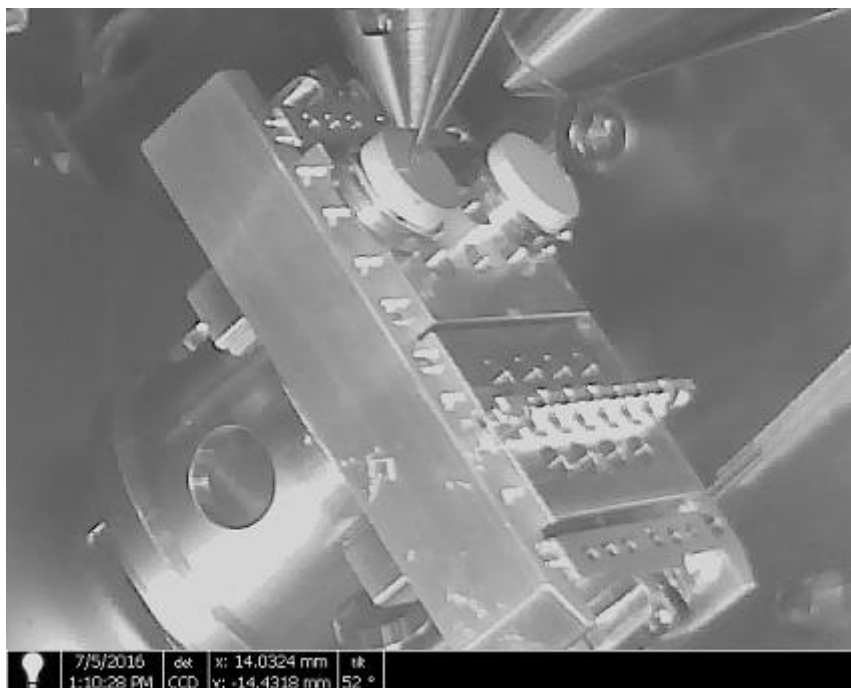
Figura 4-7. Posicionamento da amostra e colunas FIB e FEG separadas entre si em 52° ( tilt ).
