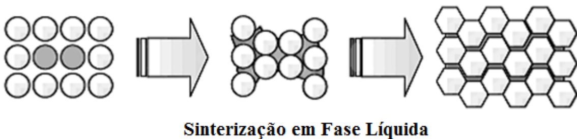
Figura 3-9. Diagrama esquemático dos estágios de sinterização em presença de fase líquida (GERMAN, 1996).
