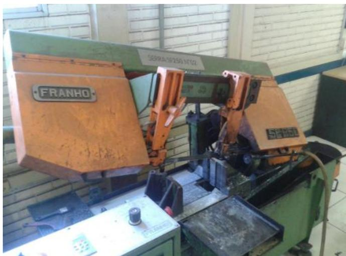
Figura 3.13. Serra utilizada para o corte das amostras. (Fonte: Cortesia Gerdau, 2016)
