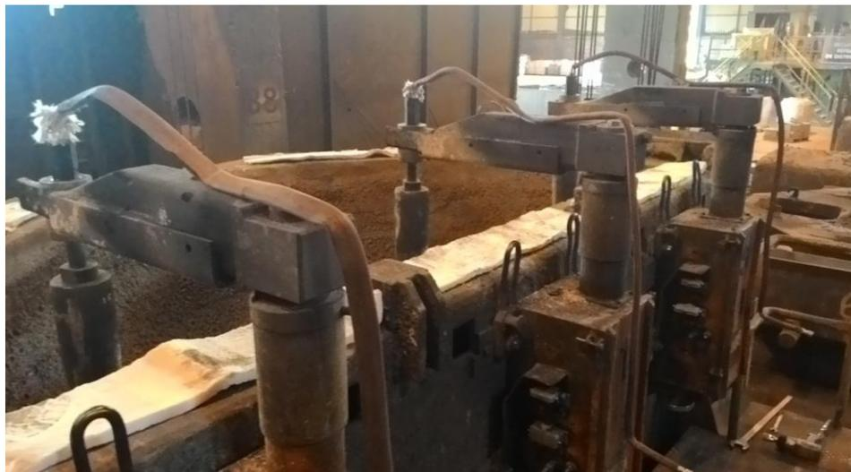
Figura 3.8: Acoplamento das tubulações de gases nos tampões.
