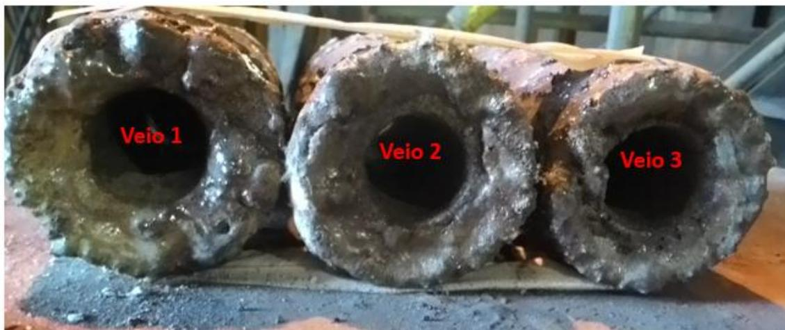
Figura 4.6: Válvulas utilizadas no lingotamento das corridas do sequencial de teste.
