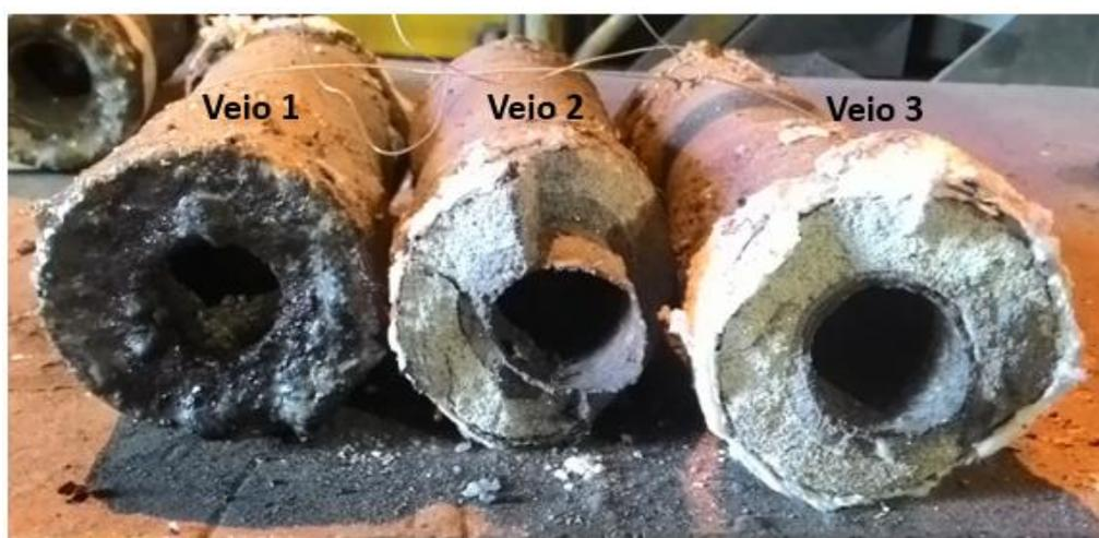
Figura 4.3: Válvulas utilizadas no lingotamento das corridas do sequencial padrão.
