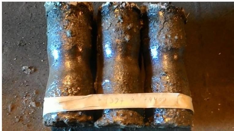
Figura 3.14: Válvulas submersas após o lingotamento.
