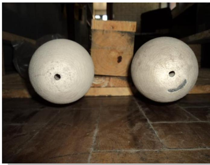
Figura 3.7: Tampão adotado nos testes, em destaque os orifícios centrais para a passagem de gás. (Fonte: Cortesia Gerdau)
