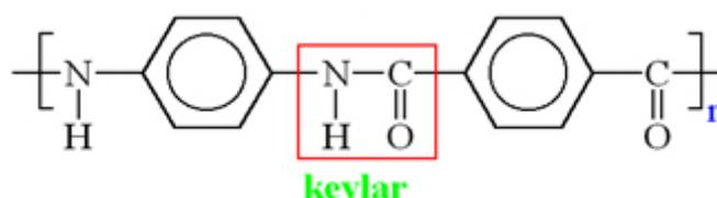
Figura 3.6: Plano de ligação de pontes de hidrogênio na estrutura do Kevlar (adaptado de <http://www.alunosonline.com.br/quimica/polimero-prova-bala-kevlar.html>, consultado em julho de 2013).
