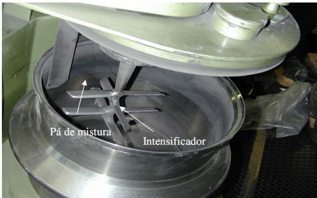
Figura 4.3: Misturador do tipo moinhos de pás, empregado na homogeneização do material.
