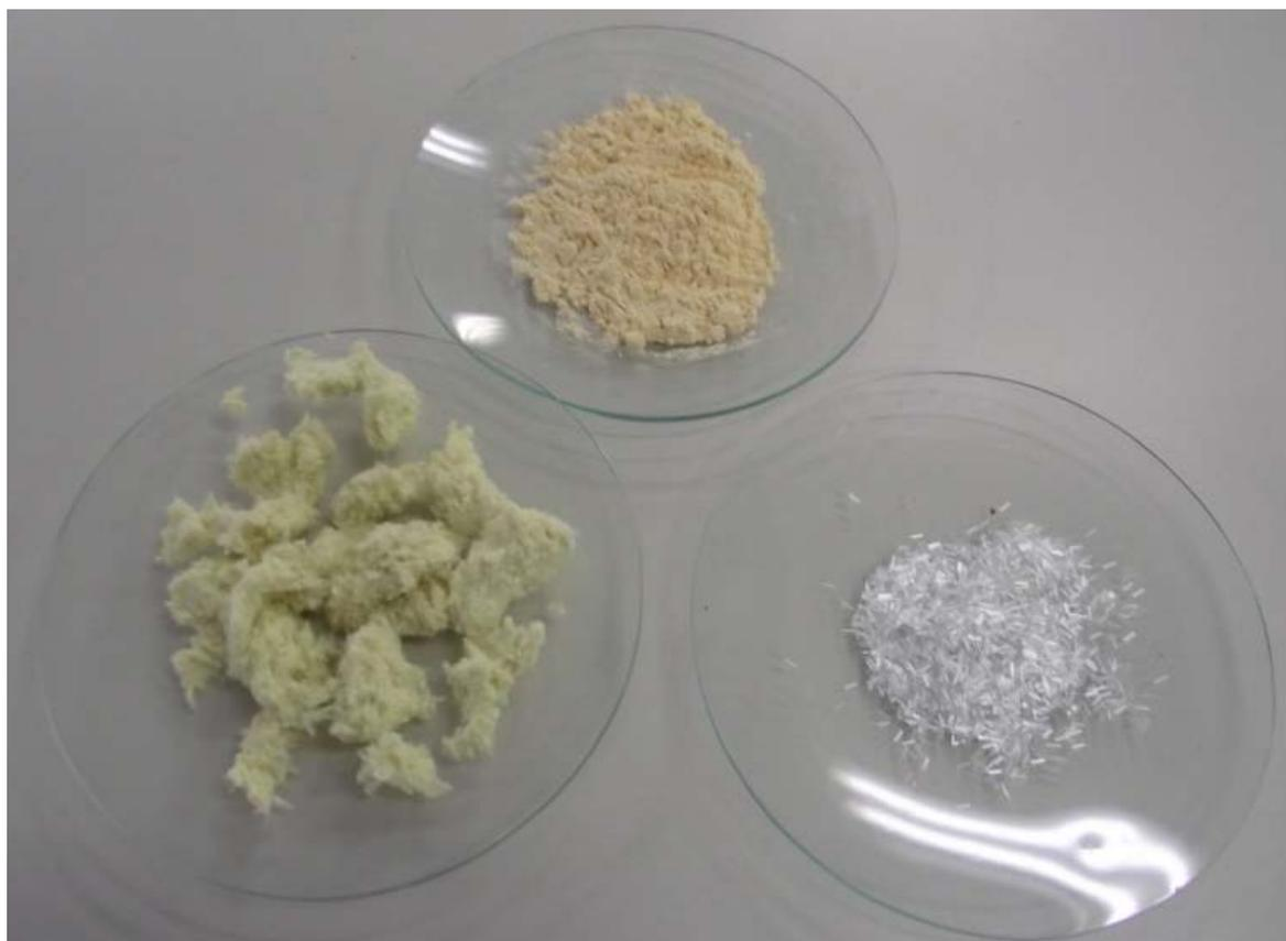
Figura 4.2: Amostras: resina fenólica (acima), fibra aramida (esquerda) e fibra de vidro (direita).
