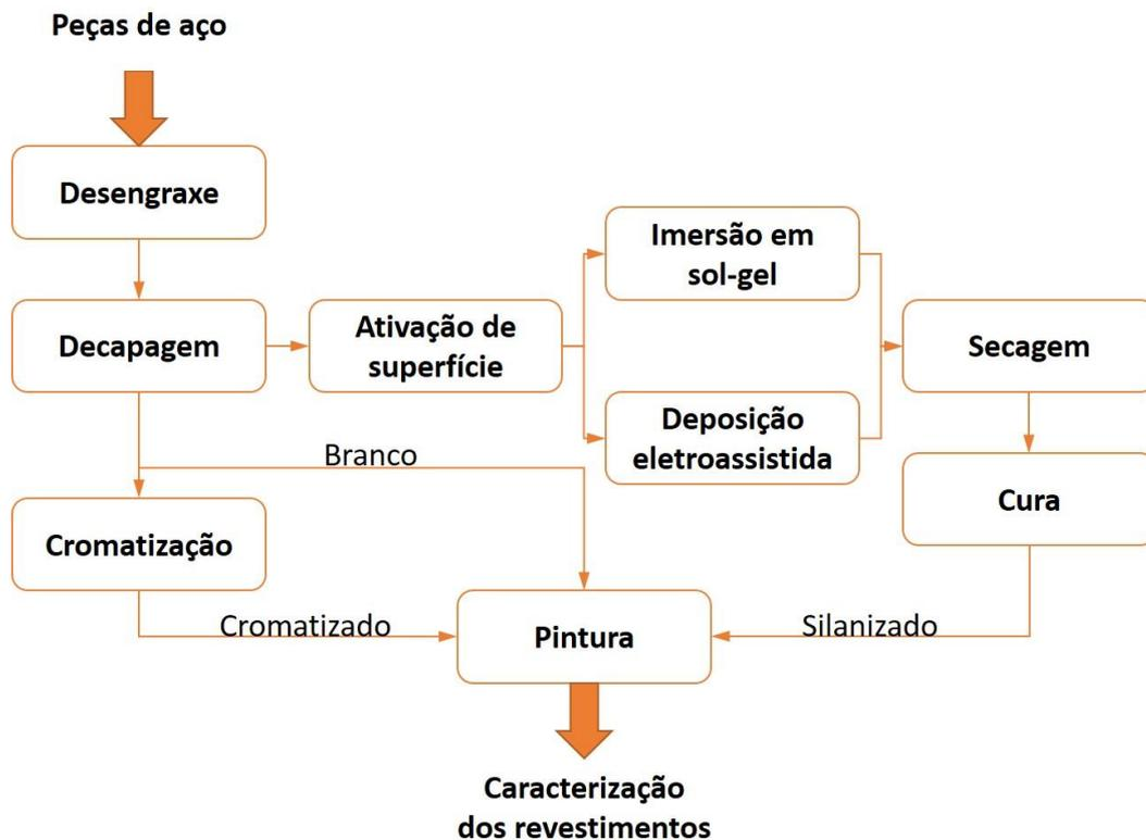
Figura 16. Fluxograma do procedimento de preparo de amostras de aço carbono AISI 1006.
