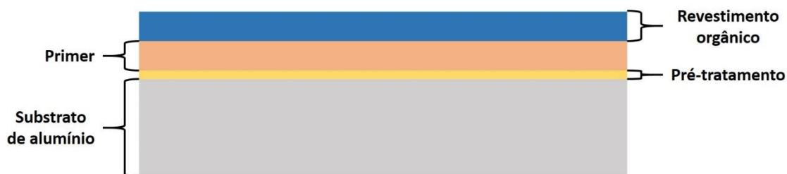
Figura 2. Ilustração das camadas típicas de um sistema de revestimento orgânico em alumínio.
