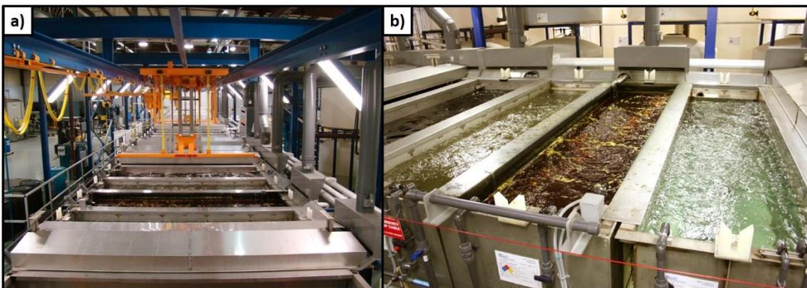
Figura 3. Processo industrial de cromatização de alumínio. a) Sequência de cubas referentes às etapas do tratamento e b) vista do conteúdo das cubas. Adaptado de [30].
