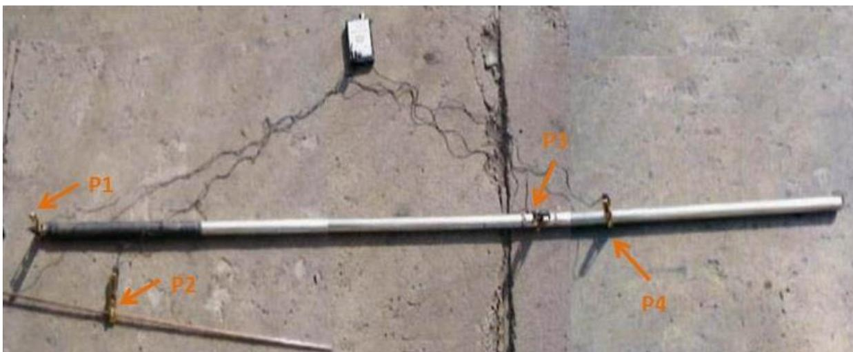
Figura 2.14 – Caixa com valores de resistividade acoplada à sonda de resistividade
