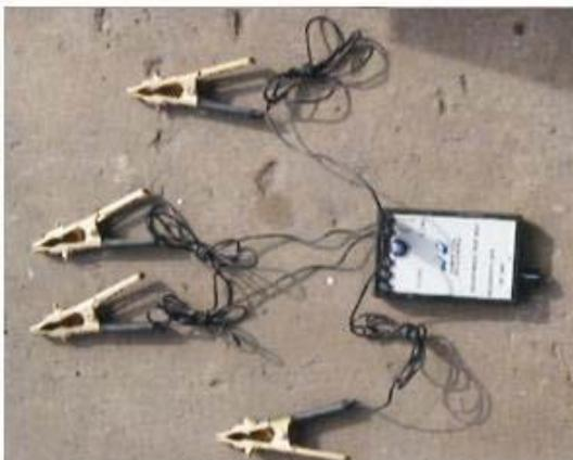
Figura 2.13 – Caixa com valores de resistividade padrão para a calibração de sonda de resistividade
