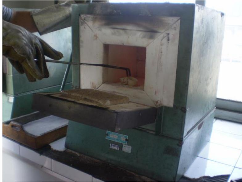
Figura 3.18 - Cadinhos contendo as amostras sendo inseridos no forno de mufla
