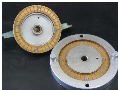
Figura 56 – Detalhe da célula de cisalhamento
