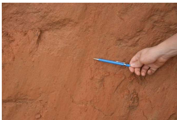
Figura 42 – Aspecto da polidez da superfície de ruptura no solo MgB
