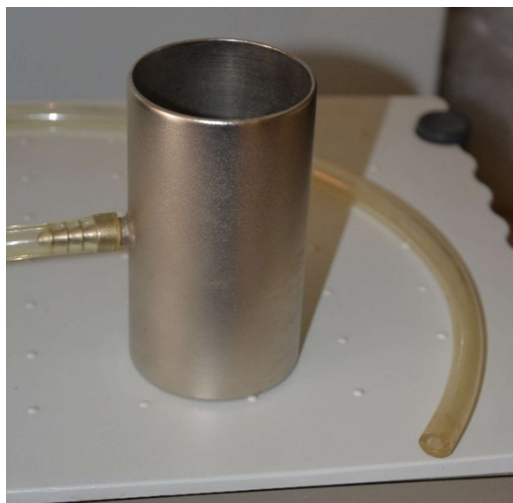
Figura 64 – Casca cilíndrica metálica e tubo plástico para instalação da membrana de látex
