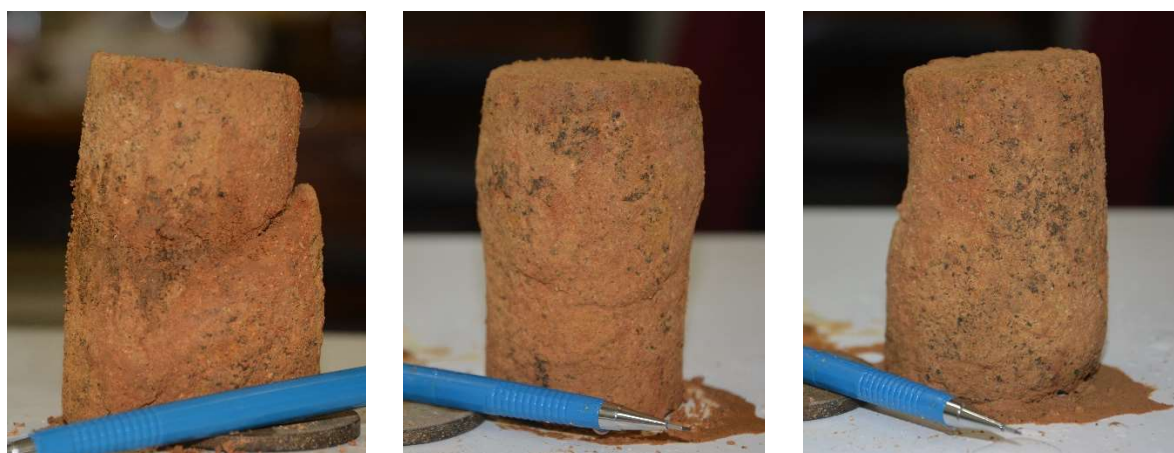
Figura 87 – Corpos de prova cisalhados, correspondentes aos ensaios com \sigma'_c=50 kPa, \sigma'_c=100 kPa e \sigma'_c=200 kPa (esquerda para direita)
