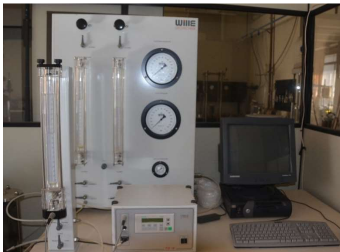
Figura 57 – Sistema de aplicação de pressões, microcomputador e transdutor de variação volumétrica
