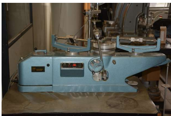
Figura 55 – Ring shear de Bromhead (1979) empregado neste trabalho
