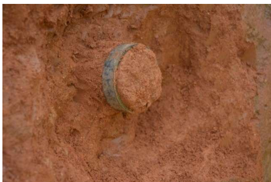
Figura 48 – Processo de inserção de um anel metálico no solo MgB
