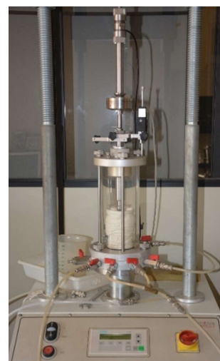
Figura 58 – Prensa, câmara triaxial, célula de carga e transdutor de deslocamentos
