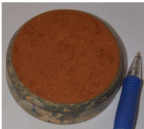
Figura 53 – Aspecto final de um corpo de prova do solo MgB
