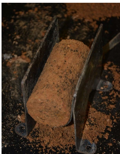
Figura 63 – Amostra sendo regularizada no berço metálico
