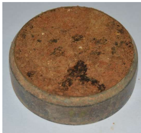
Figura 54 – Aspecto final de um corpo de prova do solo MgB-C
