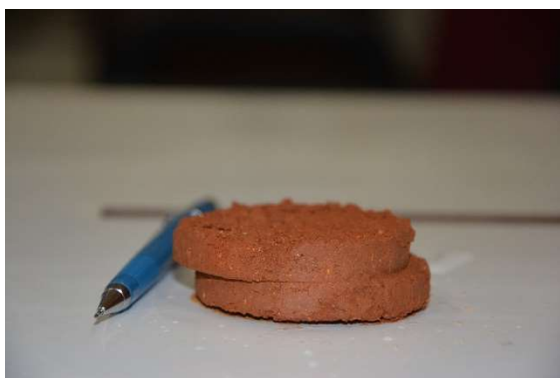
Figura 77 – Aspecto final de corpo de prova do solo MgB cisalhado
