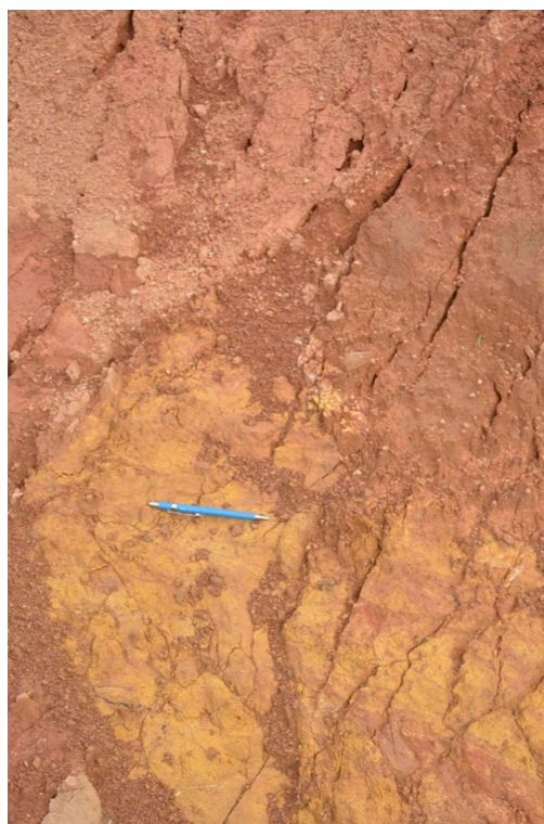
Figura 45 – Intemperização acentuada do solo SDE e contraste de coloração
