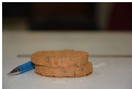
Figura 78 – Aspecto final de corpo de prova do solo MgB-C cisalhado
