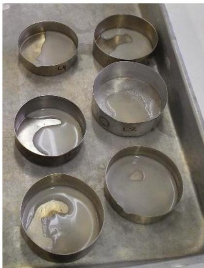
**Figura 3.8:** Cápsulas com a amostra antes da etapa de aquecimento em estufa.
