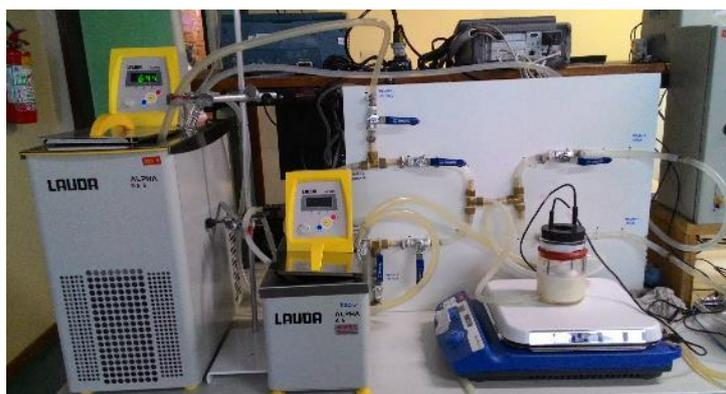
**Figura 3.4:** Banhos-água e célula de aquecimento.
