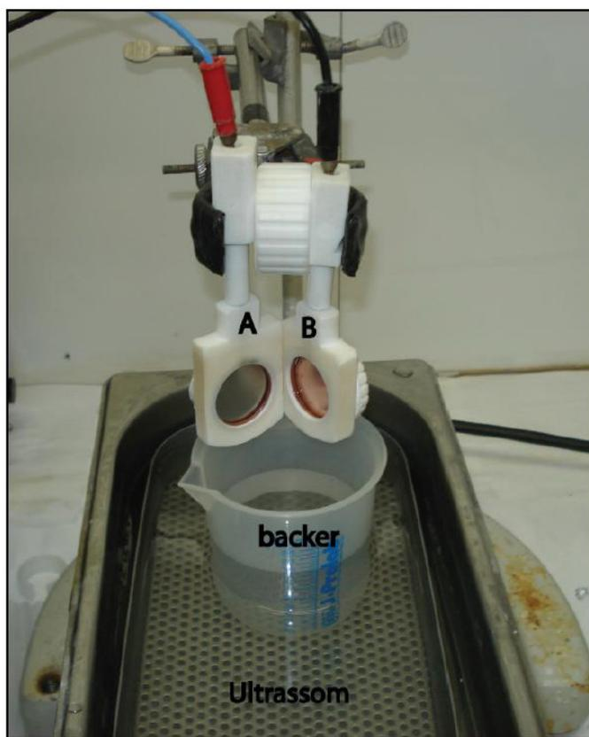
Figura 11: célula eletrolítica utilizada no sistema de anodização<sup>[25]</sup>
