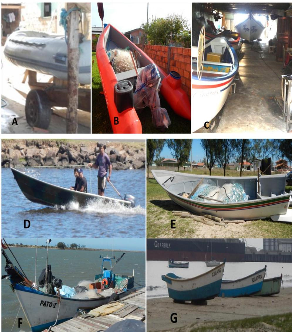
Figura 2. Variedade de botes utilizados no litoral sul do Brasil. A- Bote inflável usado em Mostardas e Cidreira (RS). B- Bote inflável usado em Passo/Torres (SC/RS). C- Botes de madeira usados em Laguna/Santa Marta (SC). Bote de verão na frente e bote de inverno ao fundo. D e E- Botes de fibra de vidro usados em Torres (RS) e Balneário Gaivota (SC), respectivamente. F e G- Botes de madeira usados em Laguna/Barra e Imbituba (SC), respectivamente.
