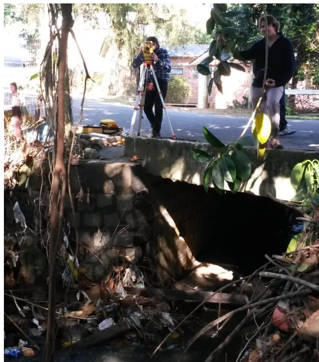
Figura 4-5. Levantamento das seções transversais em campo com o uso de Estação Total.
