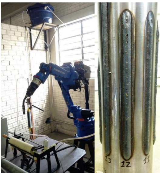
Figura 4.3 - a) Vista do experimento com o calorímetro. b) Exemplos dos cordões soldados nos tubos.
