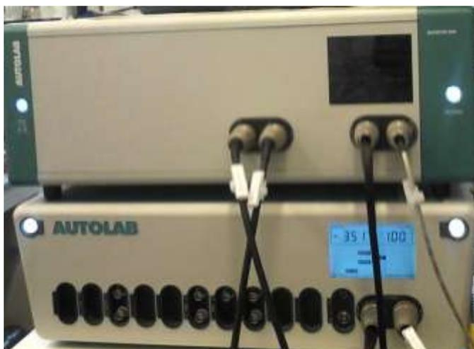
Figura 10: Potenciostato /galvanostato Autolab PGSTAT302N
