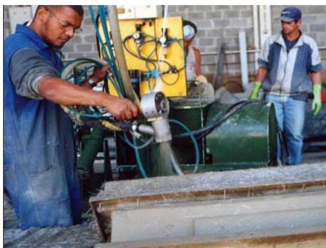
Figura 15 – (a) Pistola de projeção (b) projeção da argamassa e fibra no molde
