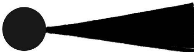
Figura 33 – Imagem de superexposição, obtida através de vídeo, mostrando a amplitude das vibrações da placa ( L/D = 3 e Re = 7000 )
