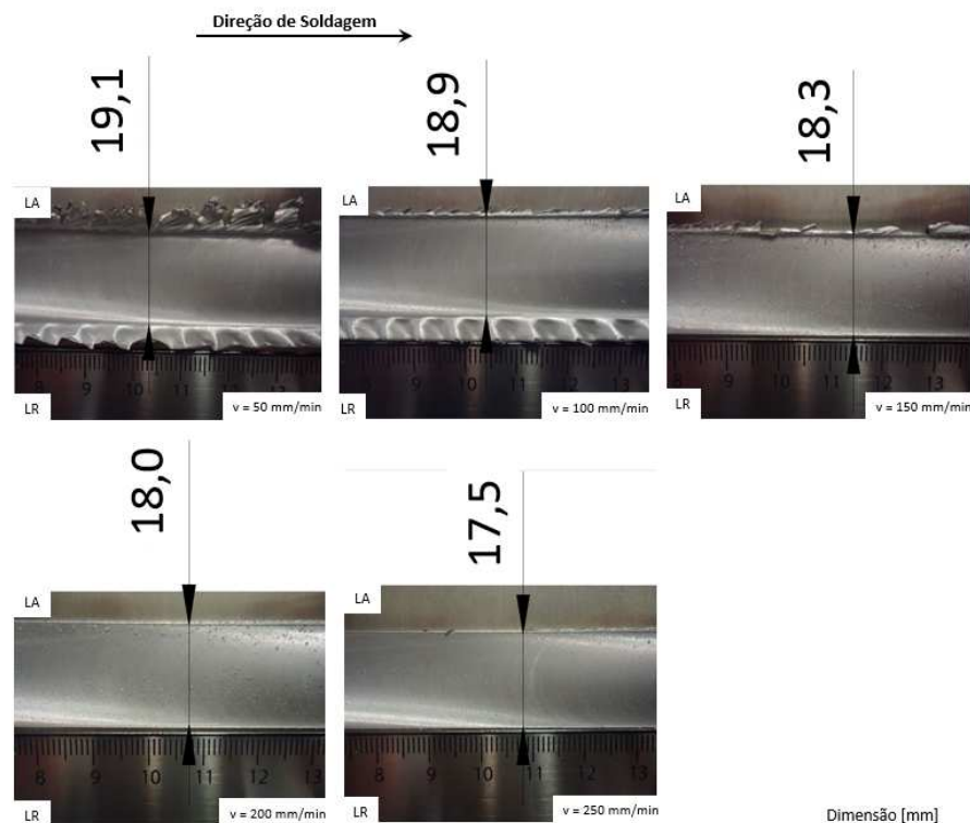
Figura 49 – Vista de topo – Largura da junta soldada.
