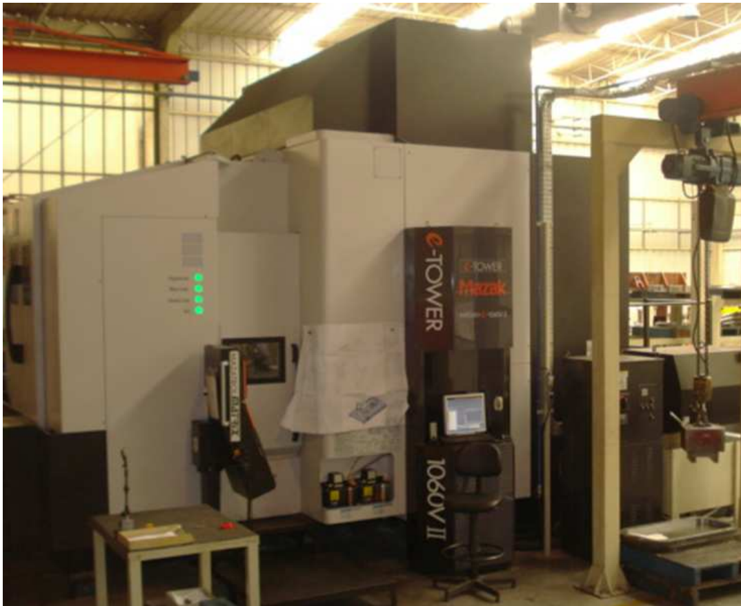
Figura 36 – Máquina fresadora CNC Integrex e1060V.
