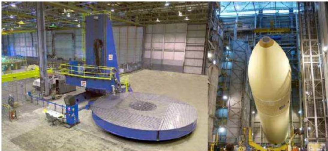
Figura 30 – Equipamento de FSW utilizado nos tanques de combustíveis do ônibus espacial.
