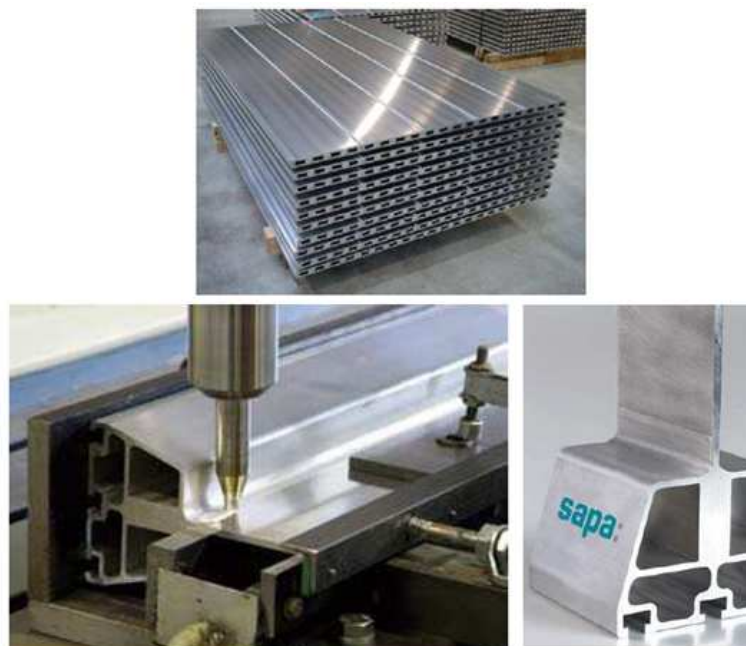
Figura 28 – Painéis fornecidos pela SAPA, detalhes do processo de união por FSW.
