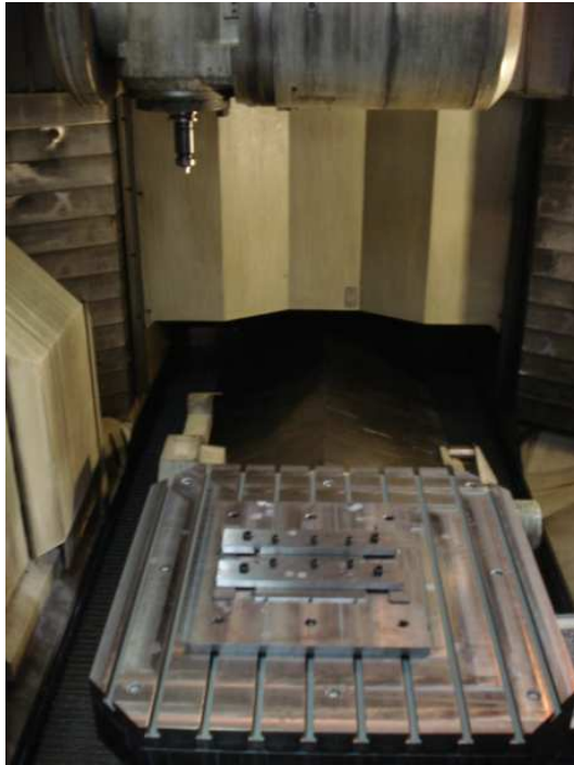
Figura 37 – Dispositivo montado na mesa da máquina Integrex e1060V.
