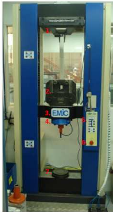
Figura 45 – Máquina universal de ensaios, utilizada para ensaio de tração.
