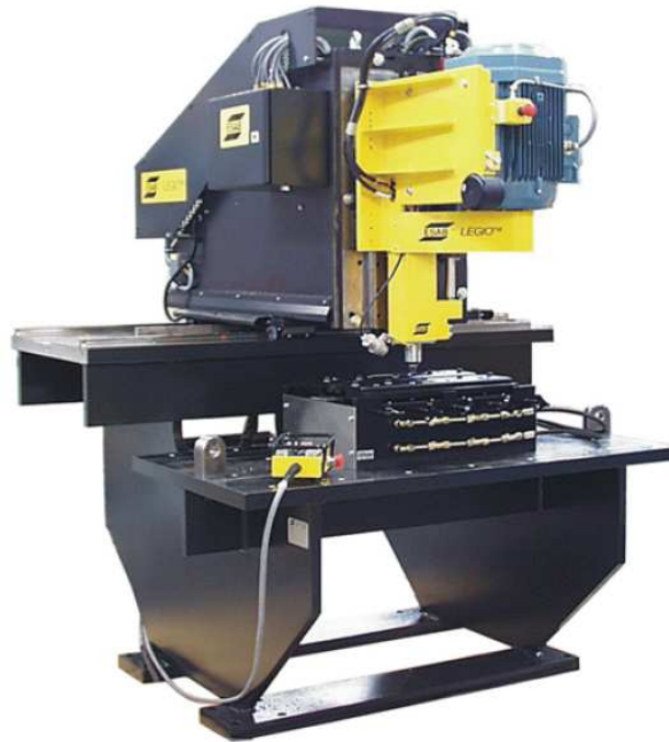
Figura 22 – Equipamento de FSW com 5 graus de liberdade.
