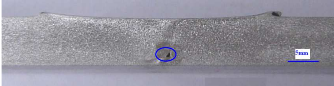
Figura 23 – Defeitos do tipo vazio, totalmente interno
