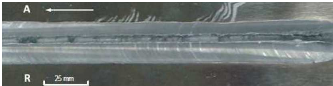
Figura 24 – Defeitos do tipo vazio, aparente a superfície da solda
