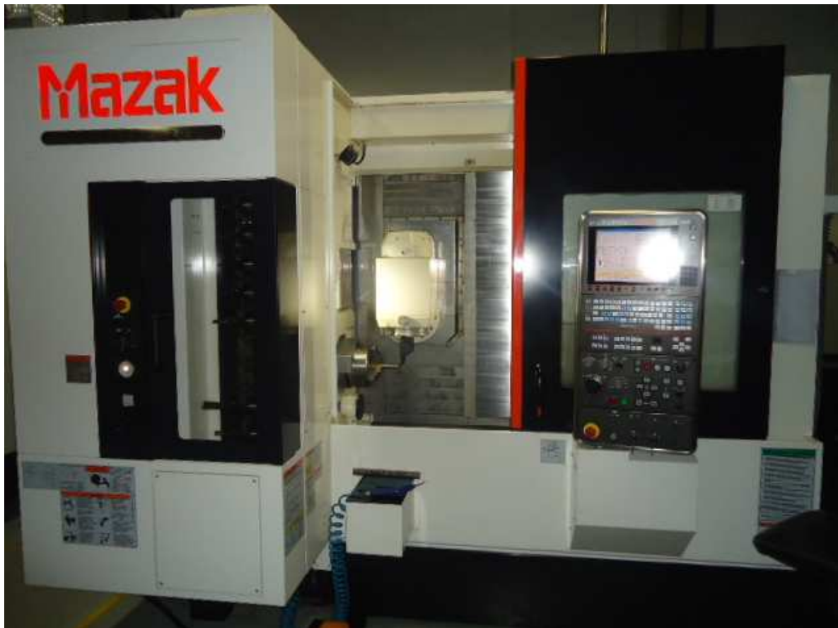
Figura 35 – Máquina Multitarefa INT_J200, utilizada para usinagem das ferramentas.
