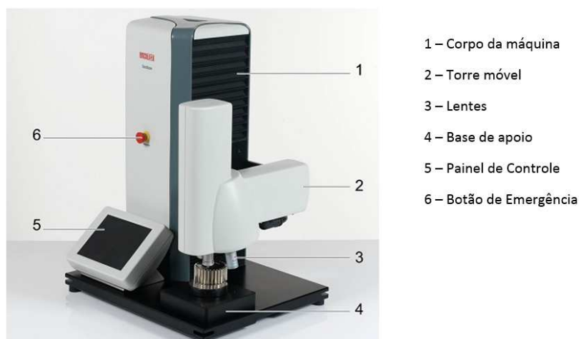
Figura 42 – Microdurômetro Emcotest DuraScan, utilizado para realização dos perfis de dureza.
