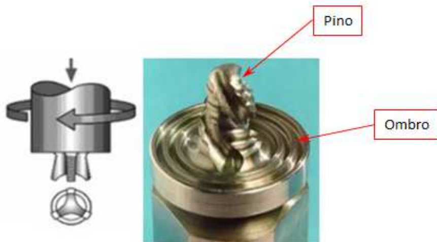
Figura 13 – Exemplificação das ferramentas, ombro e pino em detalhes.
