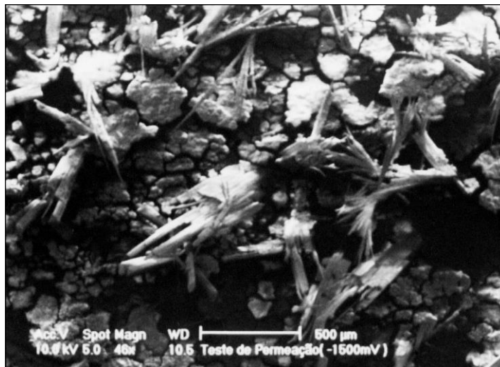
Figura 4.66 – Micrografia da amostra de ferro Armco, retirada após ensaio de permeação eletroquímica, com aplicação do potencial catódico de -1500\text{ mV}_{(\text{ENH})} .
