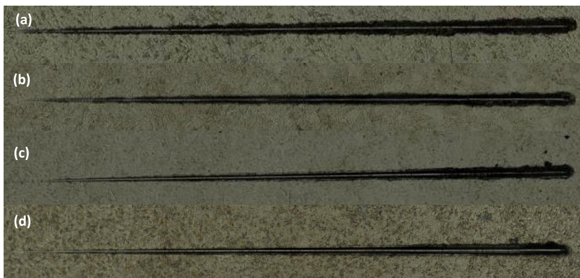
Figura 53. Trilhas de scratch dos filmes obtidos a partir de:(a) DMF; (b) DMF30LI; (c) DMF50LI; (d) DMF100LI.
