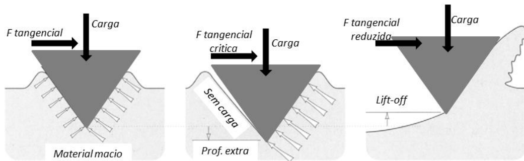
Figura 5. Ilustração esquemática da transição de contato estático para contato deslizante de uma aspereza dura em uma superfície macia (adaptado de [105]).
