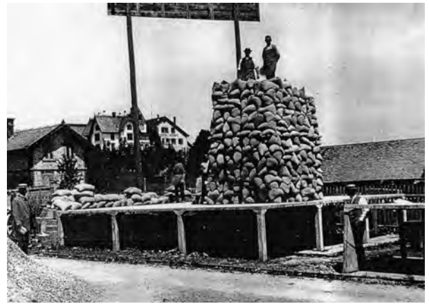
Fig. 1.55 - Robert Maillart: testes de lajes planas, 1908. [BILLINGTON, 1990]:50
