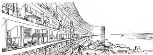
Fig. 3.40 - Le Corbusier : Urbanização da cidade de Argel , 1930-34. Estrutura robusta de concreto funcionando como arcabouço, enquadrando terrenos artificiais diversos sem prejuízo do conjunto. [COSTA, 1995]:148
