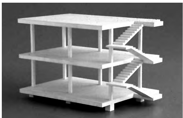
Fig. 3.12 - Le Corbusier : Sistema Dom-ino, 1914. Maquete do sistema estrutural. [FONDATION LE CORBUSIER. Le Corbusier: architecte/ artiste . London: Infinitum publications, 1997. CD-ROM. Macintosh]
