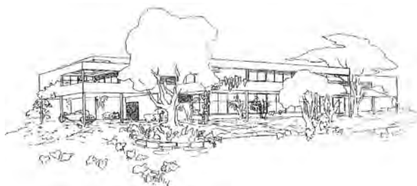
Fig. 3.51 - Lucio Costa: Casa E.G. Fontes, 1930. Perspectiva externa. A estrutura é mista, paredes e colunas são coplanares e as lajes planas. [COSTA, 1995]:60
