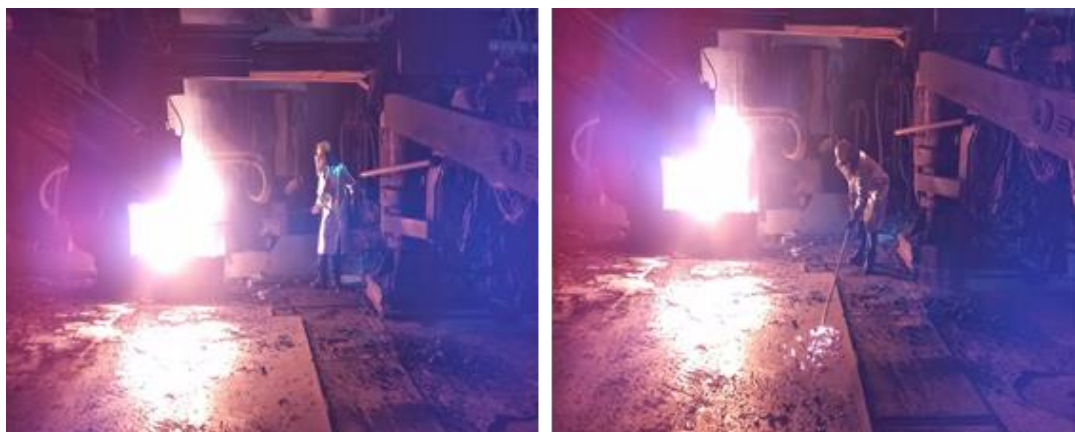
Figura 3.3 Momento de retirada de uma amostra de escória.
