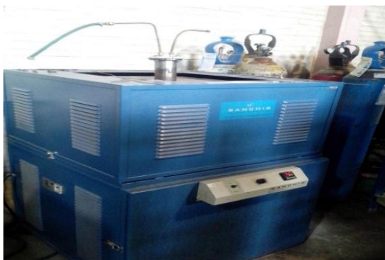
Figura 21 - Forno poço SANCHIS.
