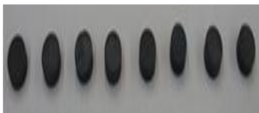
Figura 34 - Peças do composto SC sinterizado.
