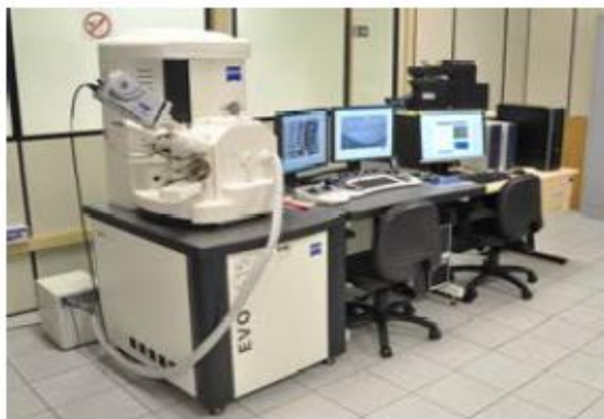
Figura 22 - Equipamento para análise de MEV e EDS.
