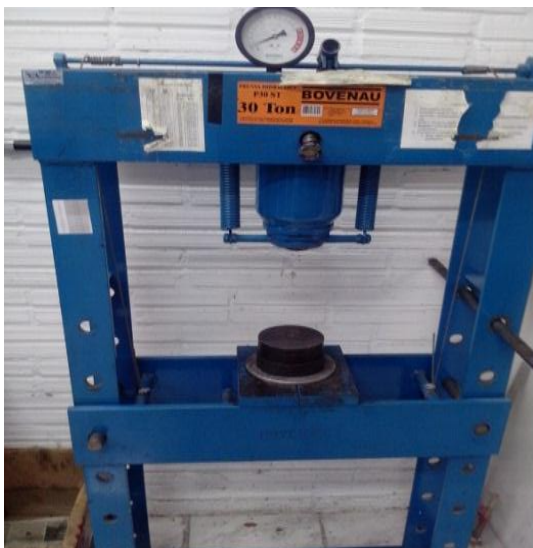
Figura 20 - Prensa de compactação.
