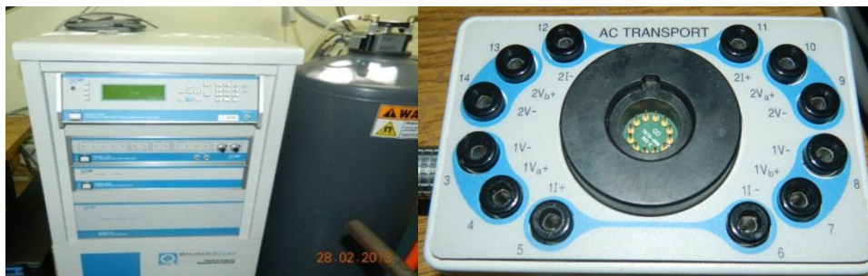
Figura 29 - Equipamento de medida da condução elétrica dos compósitos.
