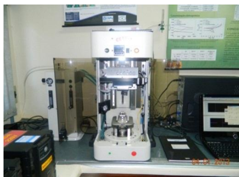
Figura 25 - Equipamento de desgaste por tribologia.
