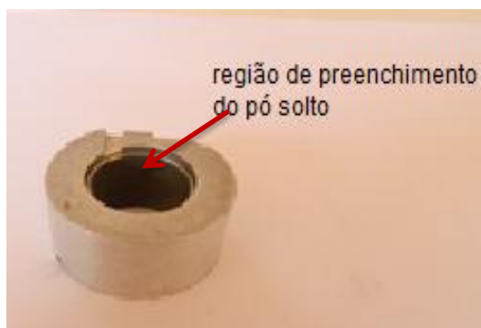
Figura 18 - Área de depósito do pó solto.
