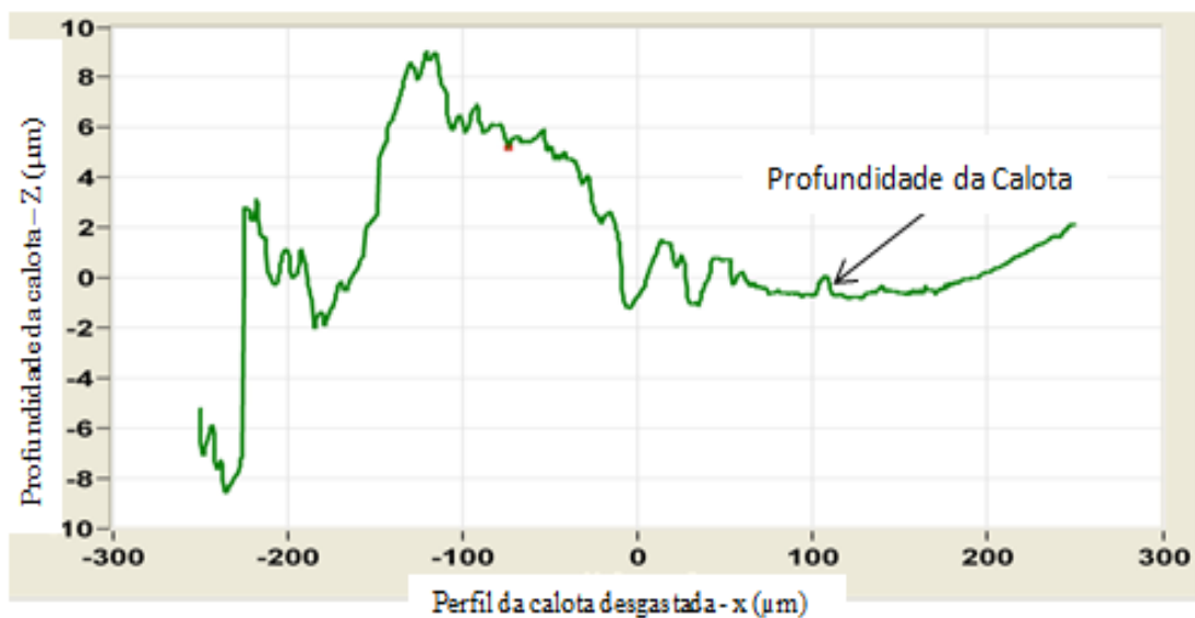
Figura 52 - Ensaio de Perfilometria da amostra do composto B.
