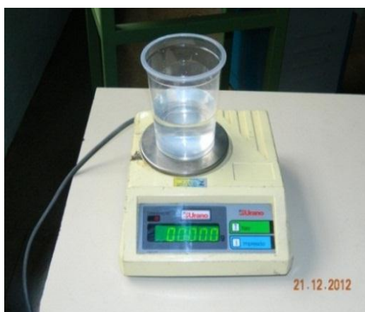
Figura 19 - Balança de precisão e recipiente com água.
