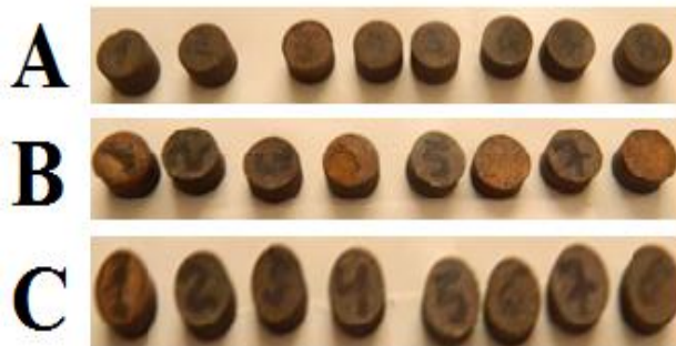
Figura 33 - Ilustração dos compostos A, B e C após a sinterização.
