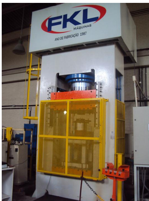
Figura 3.18 - Prensa hidráulica de 600ton, marca FKL.
