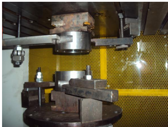
Figura 3.20 - Fixação do ferramental na prensa
