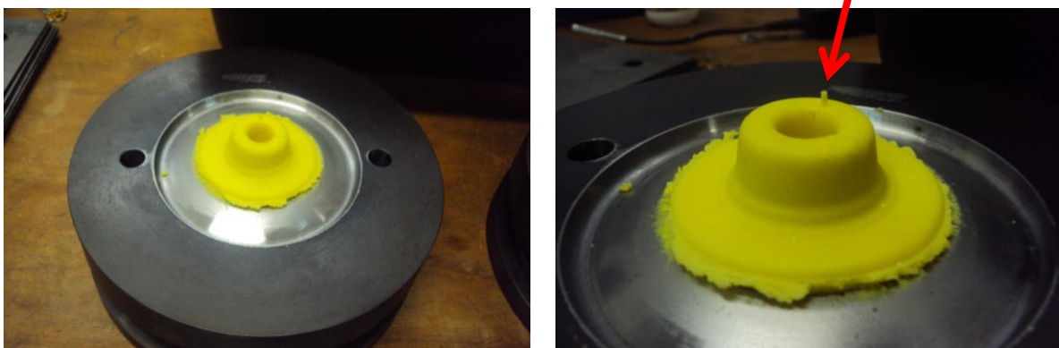
Figura 4.13 - Peça produzida em ensaio com plasticina
