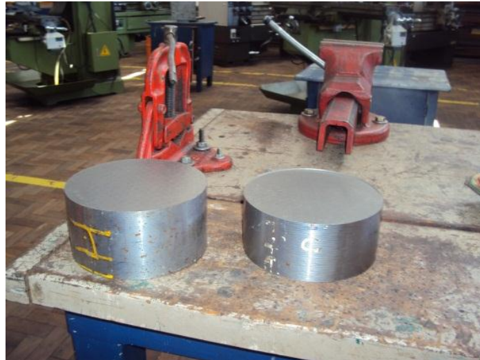
Figura 3.14 - Blocos de H13 prontos para serem usinados.
