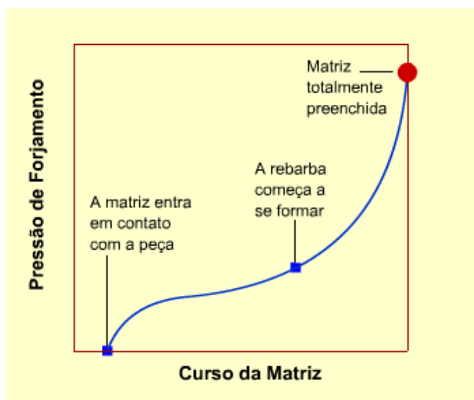
Figura 2.10 - Curva típica de pressão de forjamento. Adaptado de (DIETER, 1981).
