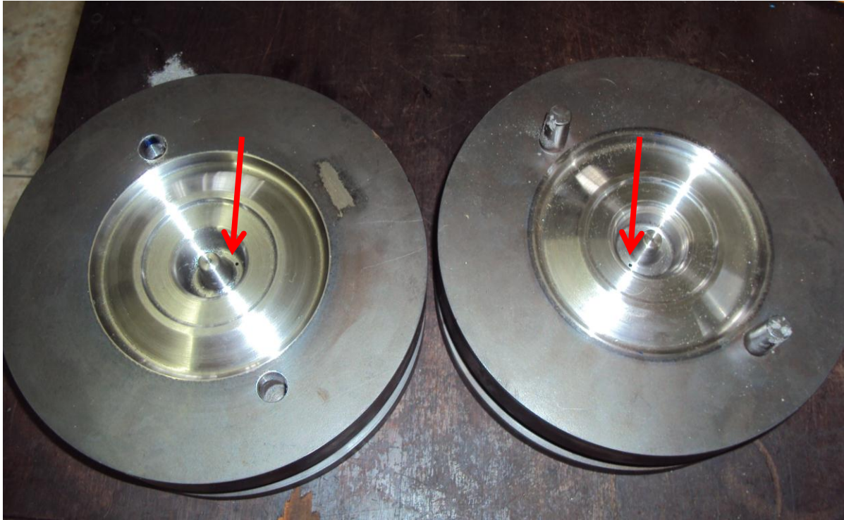
Figura 4.12 - Furos para escape de gases
