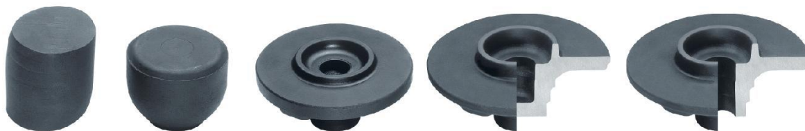
Figura 2.1 - Sequência de fabricação (HATEBUR METALFORMING EQUIPMENT LTD)
