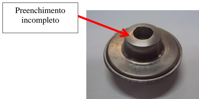
Figura 4.11 - Primeiro experimento: Preenchimento incompleto
