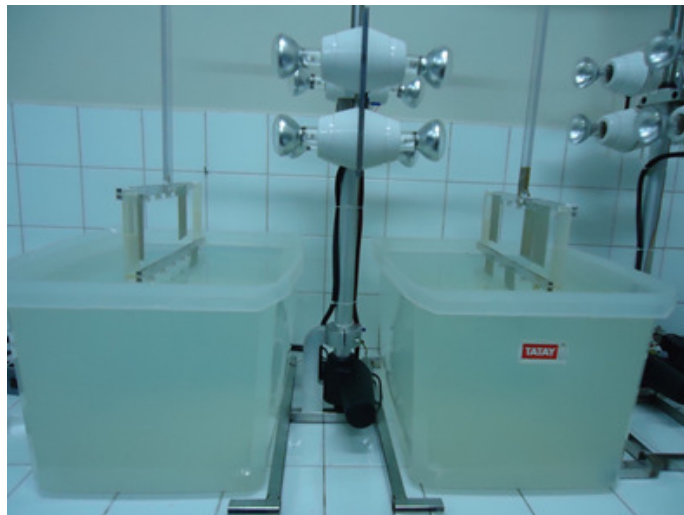
Figura 22: Robo utilizado nos ensaios acelerados de corrosão das placas pintadas.
