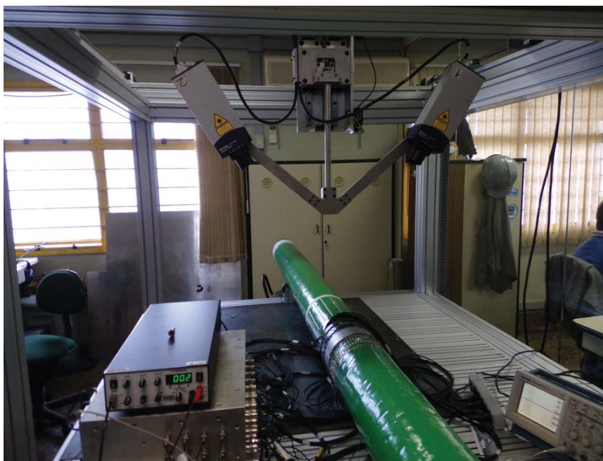
Figura 21: Bancada tridimensional utilizada para as medidas do campo acústico no corpo de prova.
