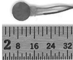
Figura 2.3.9 - Sensor miniatura utilizado para verificar a variação da pressão durante a mastigação e deglutição [Precision Measurement Company, 2013].
